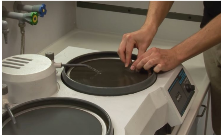
Figura 3.2 – Processo di assottigliamento
