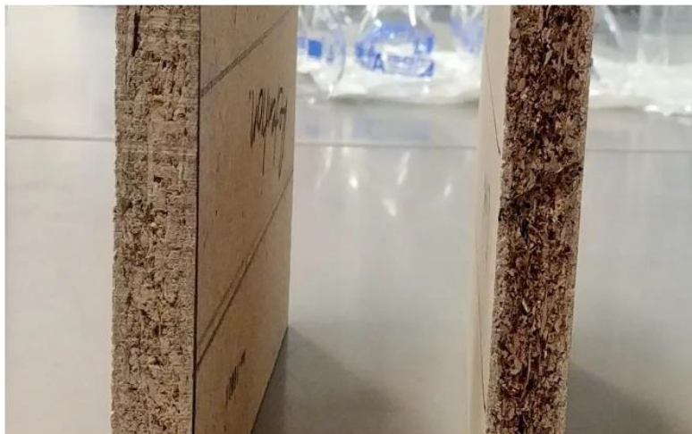
Figura 17: Tradizionale pannello truciolare di legno (a sinistra) rispetto al pannello truciolare di vite (a destra) (Wong, Sherrell, & Hendrikse, 2020).
