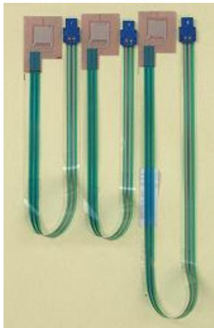
**Figura 4.4** Esempio di sonda EMG a geometria fissa, singolo differenziale
