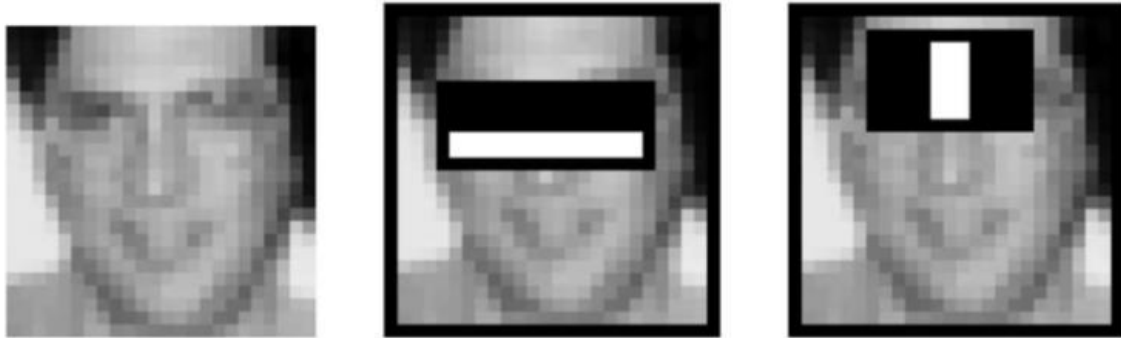
Figura 3.6 Individuazione dei rettangoli relativi a parti del volto attraverso la funzione di Haar
