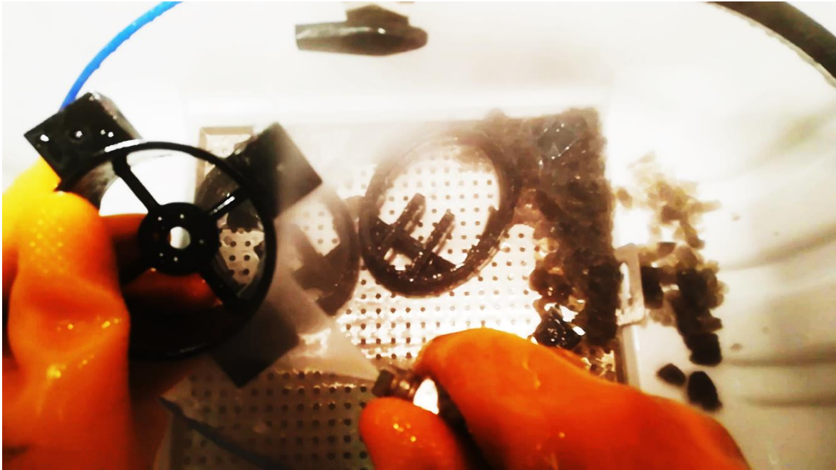
Figura 2.7 – Operazione di finitura e asportazione del materiale di supporto
