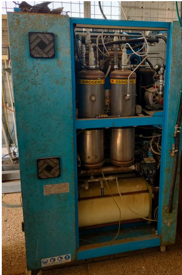
Fig.45- Elettrolizzatore alcalino installato nel DIISM.
