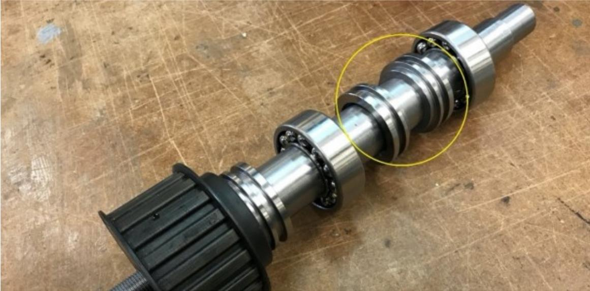
FIG.9: ALBERO DI TRASMISSIONE ASSEMBLATO CON PULEGGIA DENTATA, CUSCINETTI E LABIRINTI
