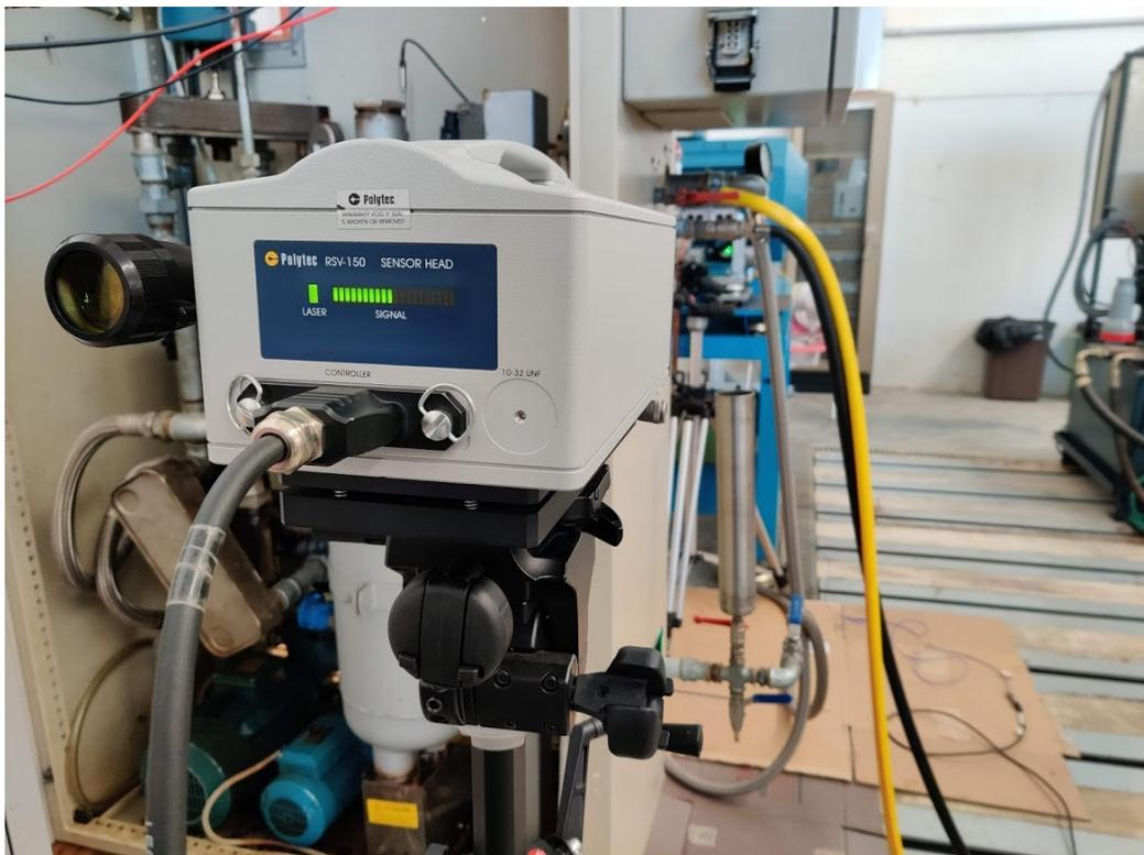
FIG. 14: VIBROMETRO POLYTEC RSV-150, MONTATO SU TREPPIEDE, ALIMENTATO E CORRETTAMENTE ALLINEATO ALLO SPECCHIO POSIZIONATO SOTTO IL BASAMENTO TESTA. EVIDENTE IL BUON LIVELLO DEL SEGNALE DI RITORNO.
