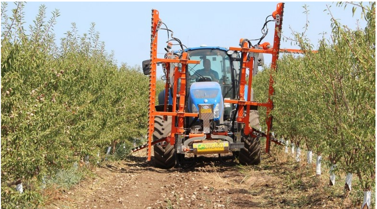
Figura 3: Potatura meccanizzata in un mandorleto superintensivo (Fruit journal).
