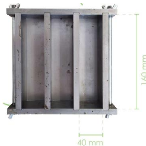
Figura 36: cassero utilizzato per gettare le miscele
