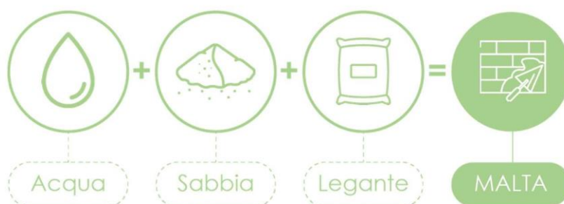
Figura 10: Diagramma dei componenti della malta cementizia
