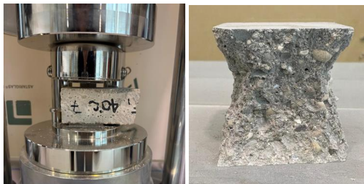
Figura 39: Provino sottoposto a prova di compressione
