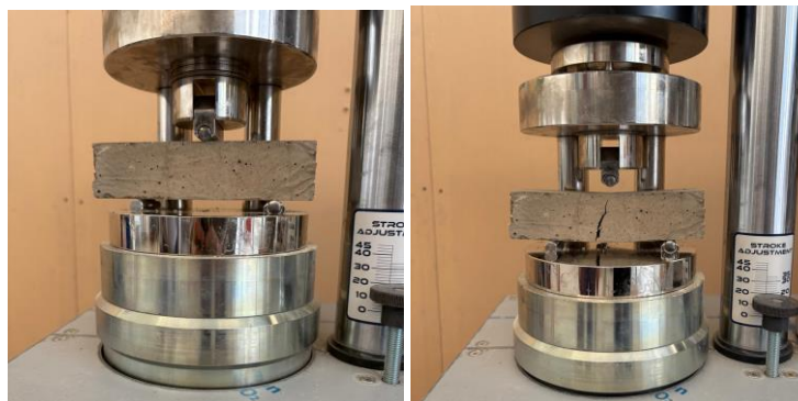
Figura 38: Provino sottoposto a prova di flessione
