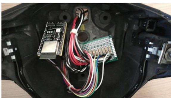
Figura 4.3: Particolare ESP32 S3 e partitore resistivo.
