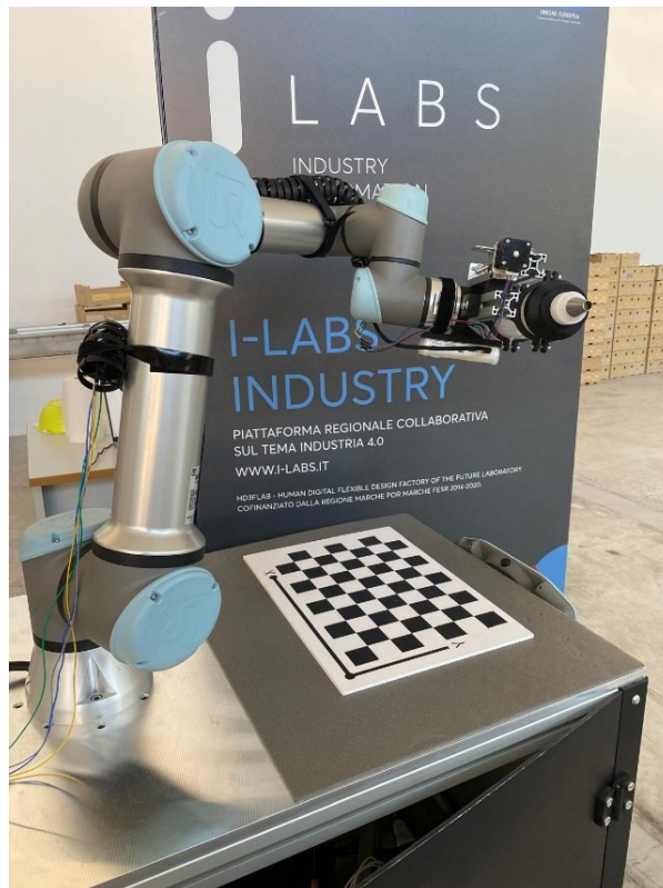
Figura 4.1: Setup sperimentale con scacchiera di calibrazione posizionata sul piano di lavoro
