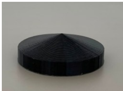
Figura 3.18 : inserto sostitutivo della guarnizione originale dello stantuffo
