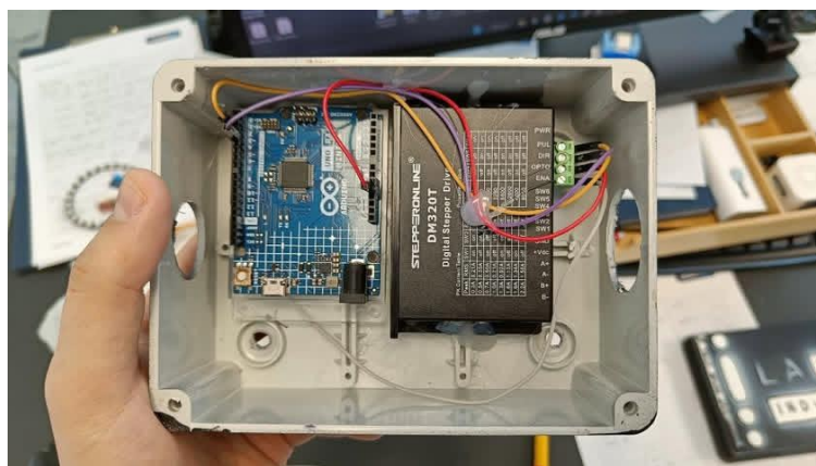
Figura 3.23 : Box con a sinistra scheda Arduino Uno R4 Minima e a destra driver DM320T
