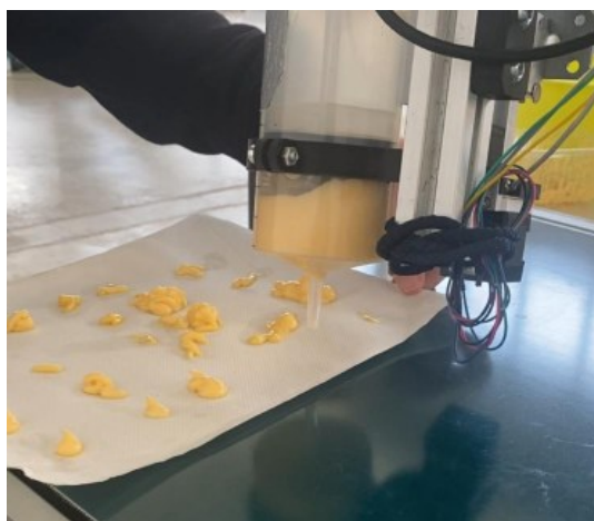
Figura 7.2: Prove di deposizione su carta nella configurazione iniziale: depositi di dimensione e forma irregolari
