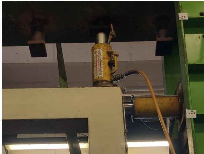
Figure 2.4 – MARTINETTI NEL NODO (B)
