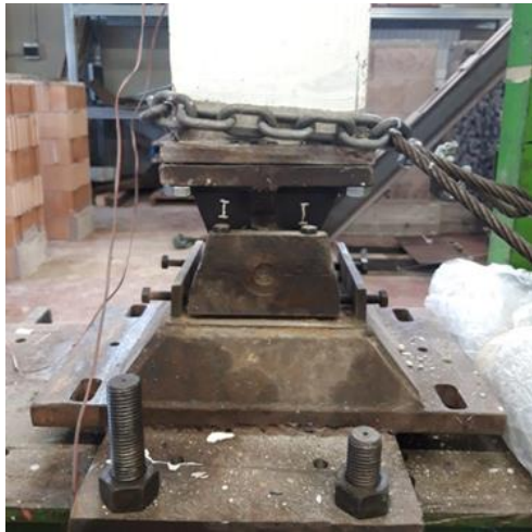
Figure 2.3 – CERNIERA DI BASE
