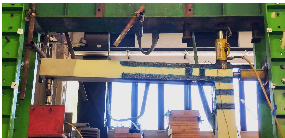
Figure 4.17 – ELEVATA INFLESSIONE DELLA TRAVE
