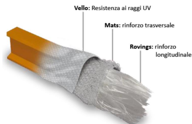
Fig. 3.8: Composizione componenti pultrusi
