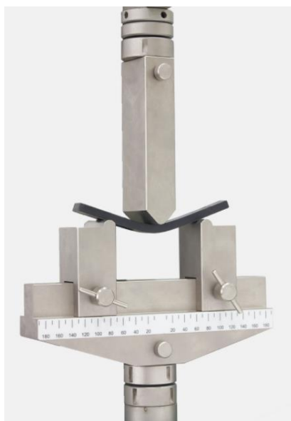
Fig. 4.4: Test di flessione a 3 punti
