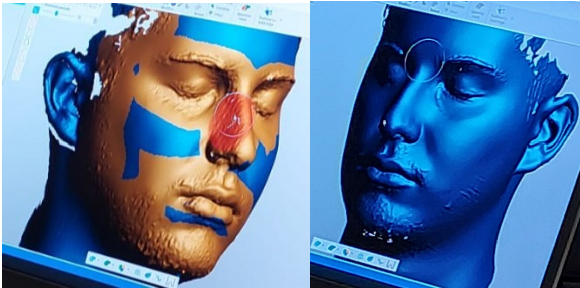
Figura 5.2.4 Risultato dopo l'operazione di eliminazione difetti
