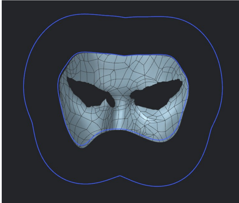
Figura 5.2.7 La forma della maschera dopo la prima estrusione
