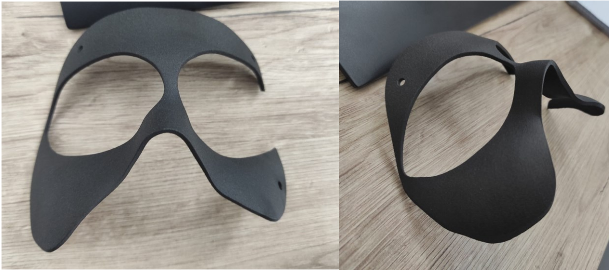
Figura 5.3.4 La maschera protettiva facciale in PA603CF
