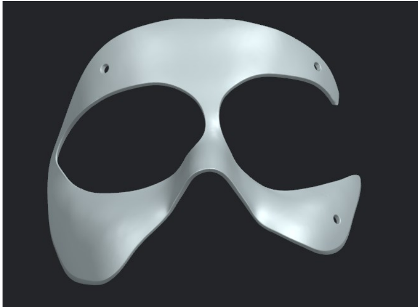
Figura 5.2.12 Risultato finale della modellazione. Maschera in formato STL pronta per essere stampata
