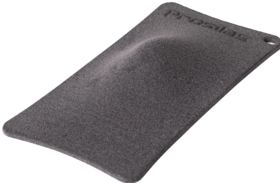
Figura 2.1.4 TPU Black dopo essere stato processato. Materiale senza finitura. [5]
