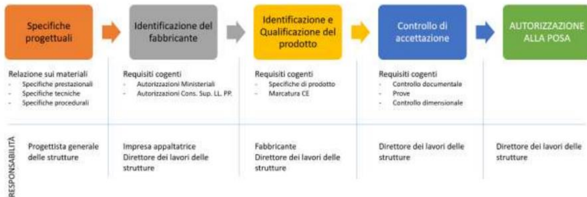
Figura 2.23: Diagramma per l'autorizzazione alla posa e collaudo dei dispositivi
