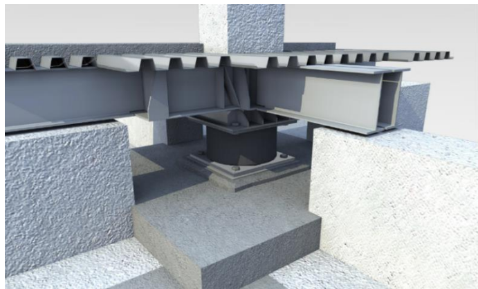
Figura 3.4: Isolamento alla base del pilastro
