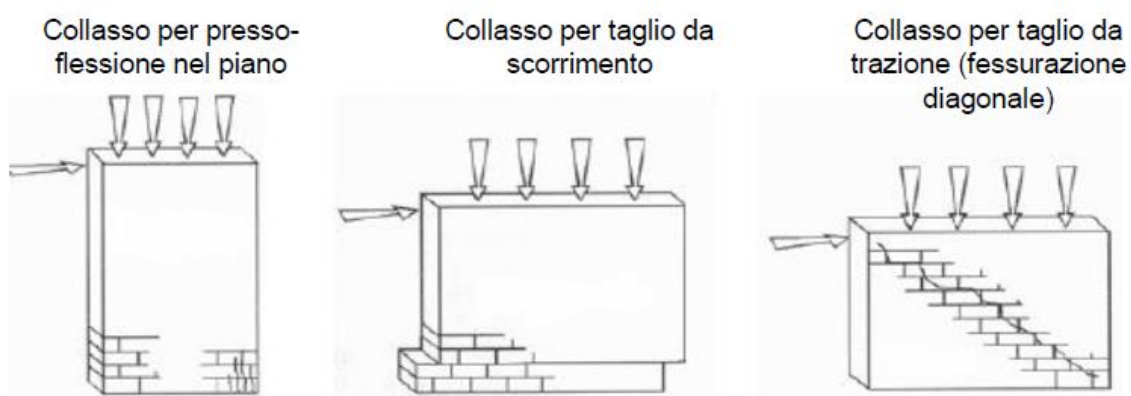
Figura 4.4: Meccanismi di collasso muratura
