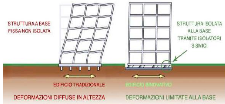
Figura 2.2: Comportamento struttura isolata
