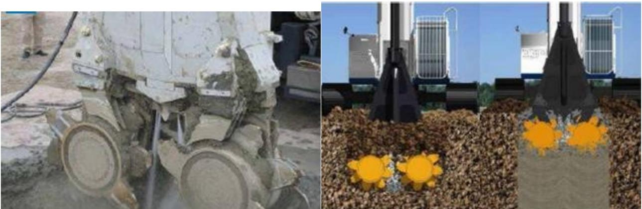
*Fig. 2.9 – Esempio di tecnologia di jet-iniezione combinata (CTJet, [www.trevispa.com](http://www.trevispa.com)).*
