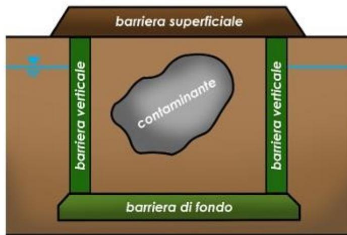
*Fig.1.1 – Sezione verticale di un sistema di incapsulamento completo (Daniel e Bowders, 1994).*
