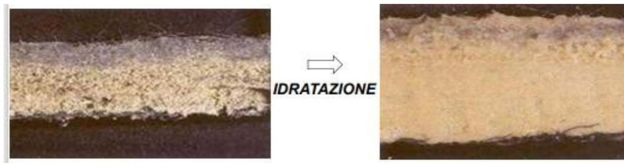
*Fig.3.3 – Capacità della bentonite di rigonfiarsi e formare gel quando idratata.*
