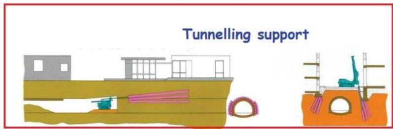
*Fig. 4.4 - Campi di Applicazione del jet-grouting.*
