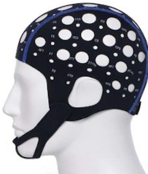
Figura 2.3: cuffia per elettrodi. La cuffia è formata da una serie di fori nei quali verranno inseriti gli elettrodi con i quali si vuole fare la misurazione; vicino ad ogni foro c’è scritto il nome dell’elettrodo corrispondente.
