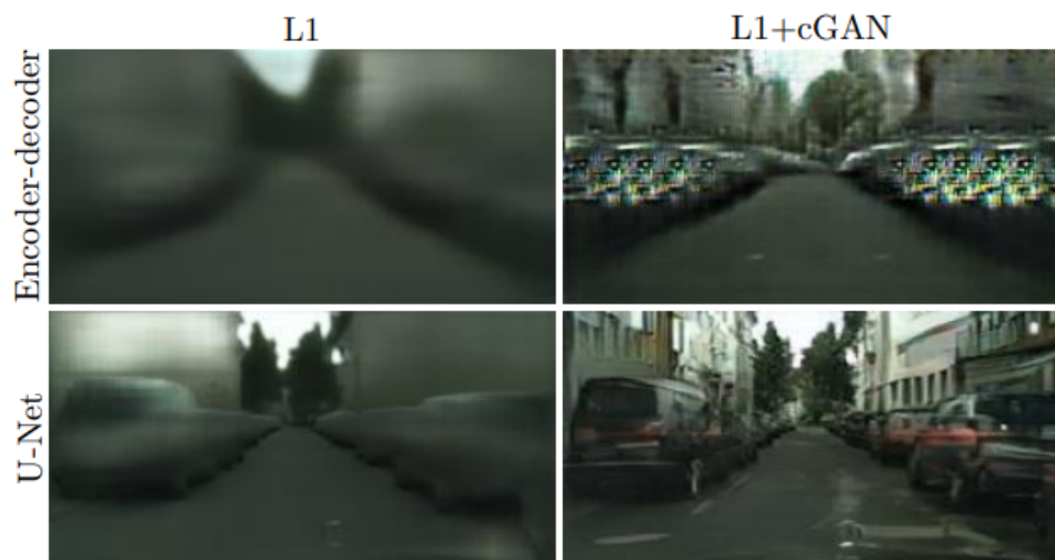
Figura 2.18: In questa immagine è possibile vedere una comparazione di un sample generato da 4 diversi modelli per il task labels to scene , i quattro esempi illustrano l'utilizzo o meno delle skip connection e l'utilizzo di una loss L1 a una loss L1 più conditional adversarial loss . credits: Phillip Isola et al. [15]
