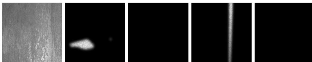
Figura 4.1: Figura che illustra un esempio di input di COIGAN, il quale è un tensore di 7 canali, in questo caso con un'immagine RGB e 4 canali per le maschere che effettuano il condizionamento della generazione dei difetti.
