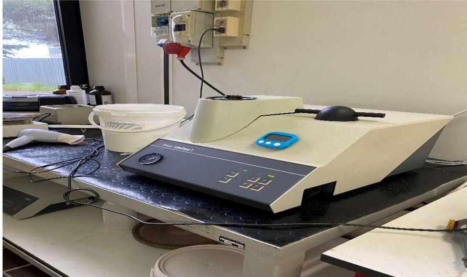
*Figura 2.4: Macchina per l'inglobamento del campione*
