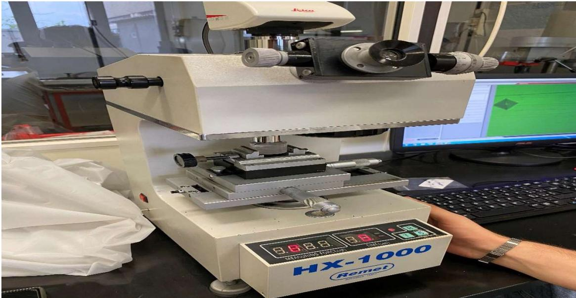
*Figura 2.6: Durometro per la prova di micro-durezza Vickers*
