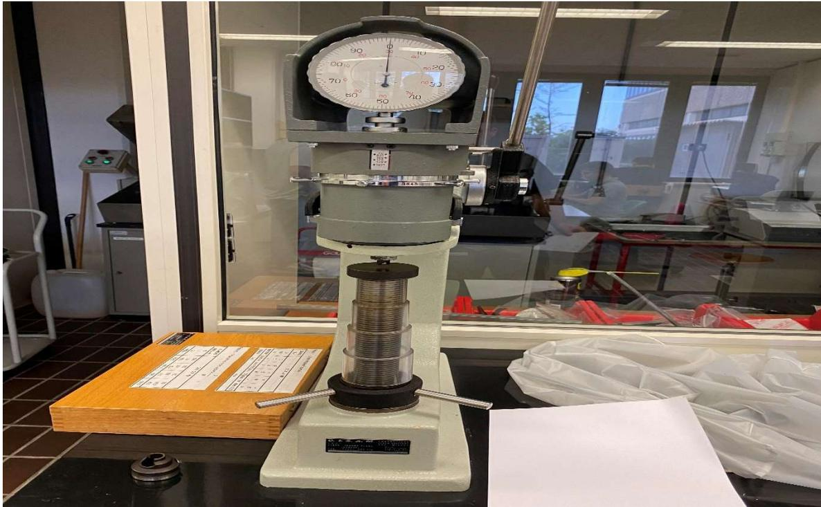
*Figura 2.7: Macchina per la prova di durezza HR B.*
