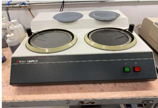
Figura 2.5: Due dei quattro piatti utilizzati nella sgrossatura del campione
