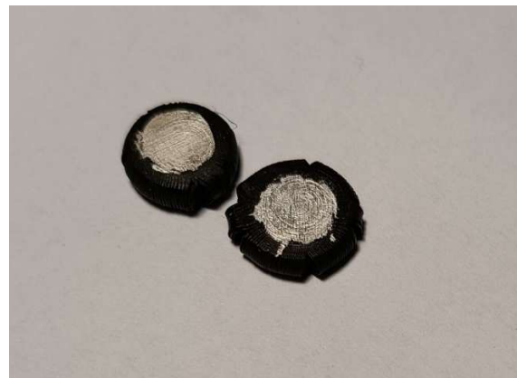
Figura 5.5: Strato di smalto conduttivo mostrato su provini deformati
