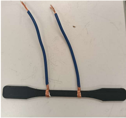
Figura 6.3: Provino con piste conduttive e cavi di rame
