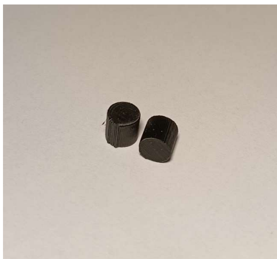
Figura 5.2: Immagine dei provini stampati per la prova di compressione
