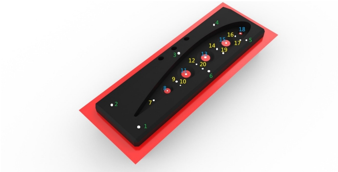
Figura 25: piano di riferimento e configurazione dei punti presi. In verde i punti del piano superiore; in giallo i punti del piano intermedio; in rosso i punti del piano inferiore
