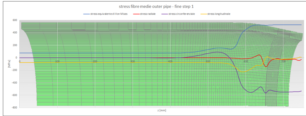
(a) Caso 1 - Distribuzione degli stress lungo le fibre medie dell'outer pipe al termine dello step 1 nel caso di hardening combinato senza Lüders Plateau
