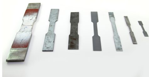
Figura 2.11: Provini piatti per la prova di trazione monoassiale.
