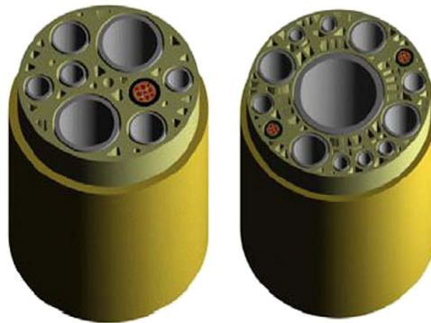
Figura 1.2: Dettaglio di un sistema ombelicale
