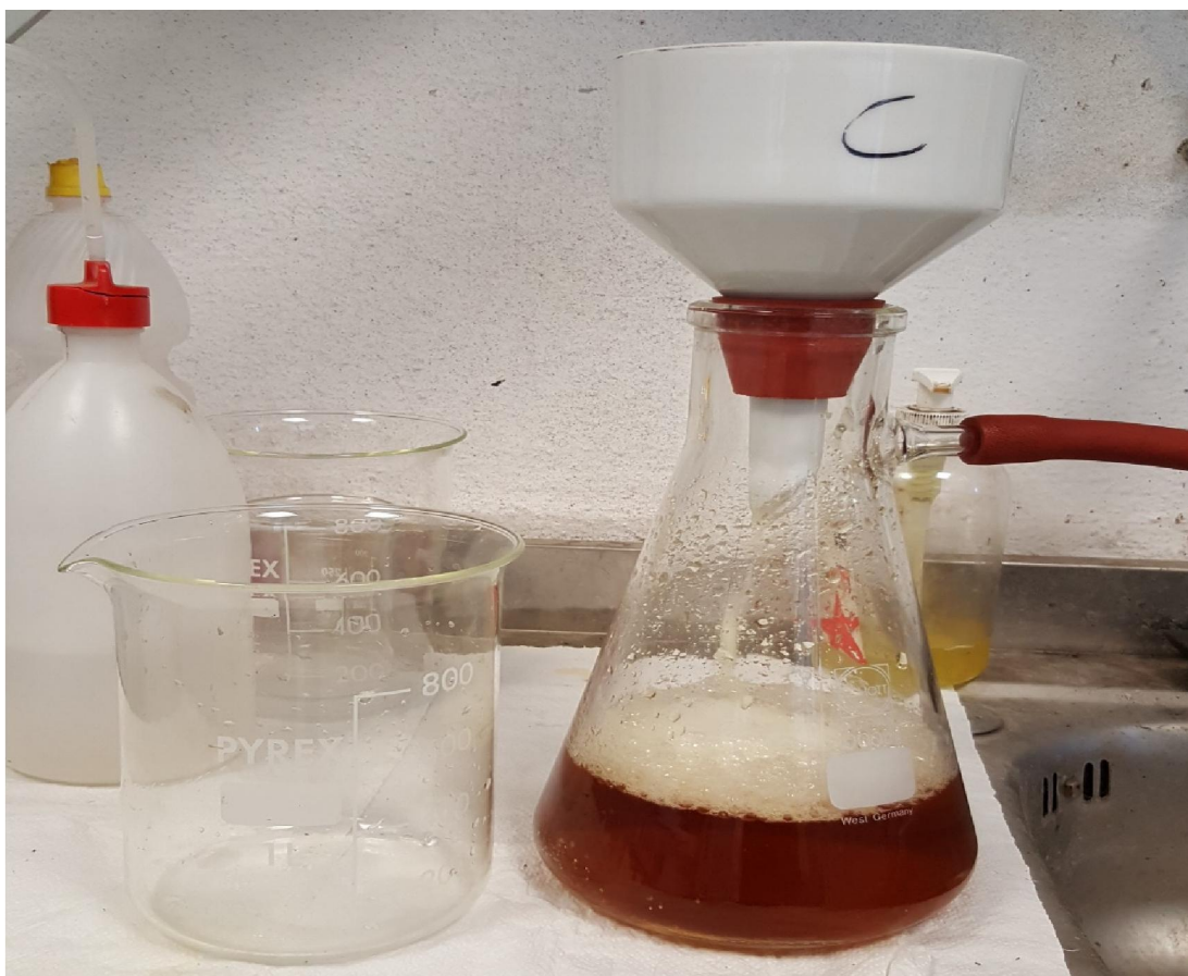
Figura 23: Sistema di filtraggio con fasi separate
