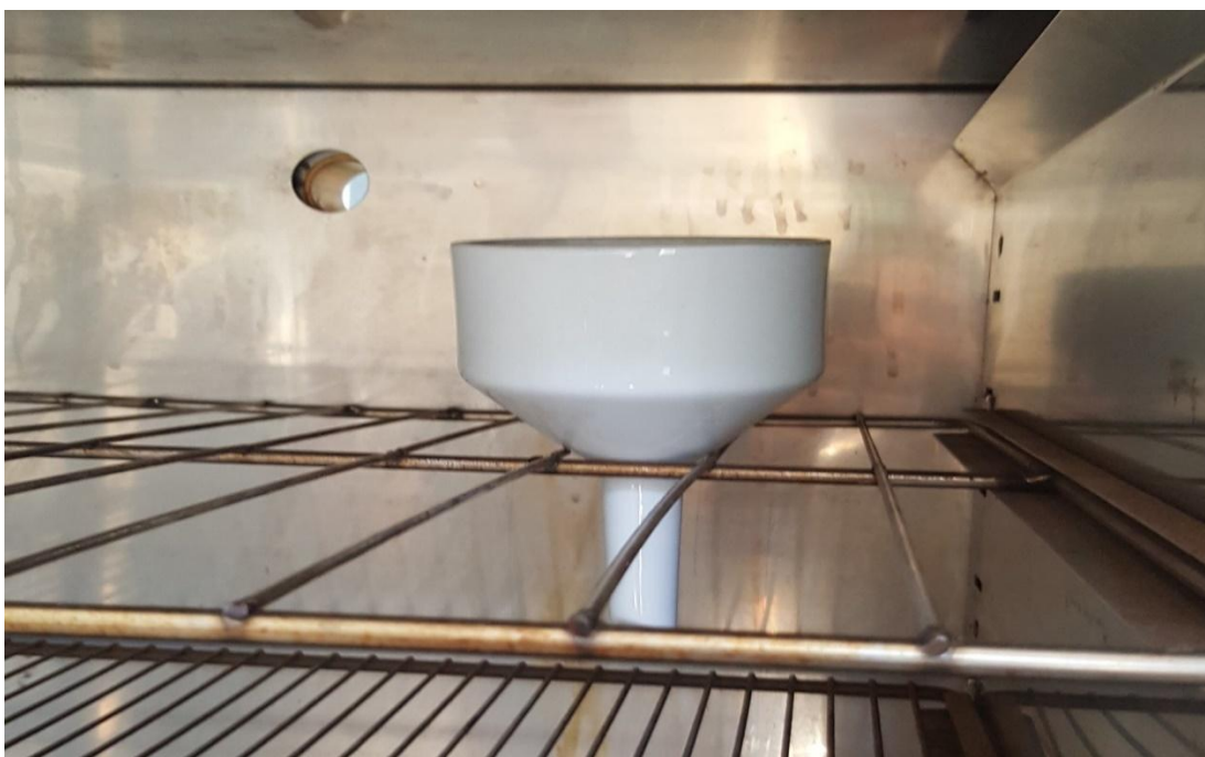
Figura 24: Campione posto in stufa per la stabilizzazione
