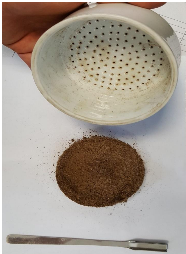
Figura 26: Biomassa e filtro recuperati dal buchner
