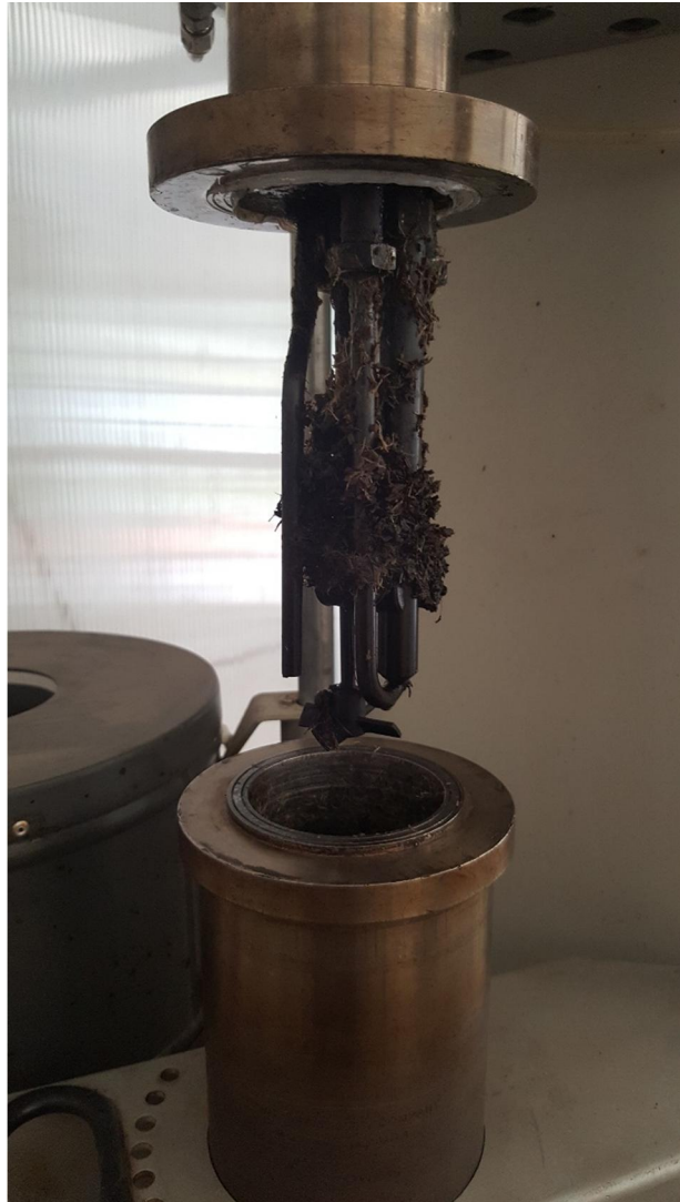
Figura 21: Vessel su carrello e sistema di miscelazione imbrattato di biomassa trattata
