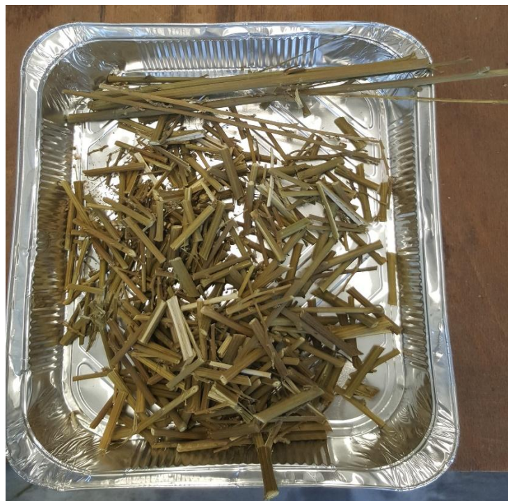
Figura 17: Steli ridotti a dimensioni di 5 cm
