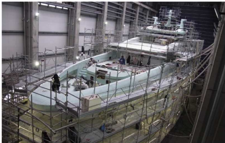
Figura 5.4 Levigatura finale dello scafo. [9]
