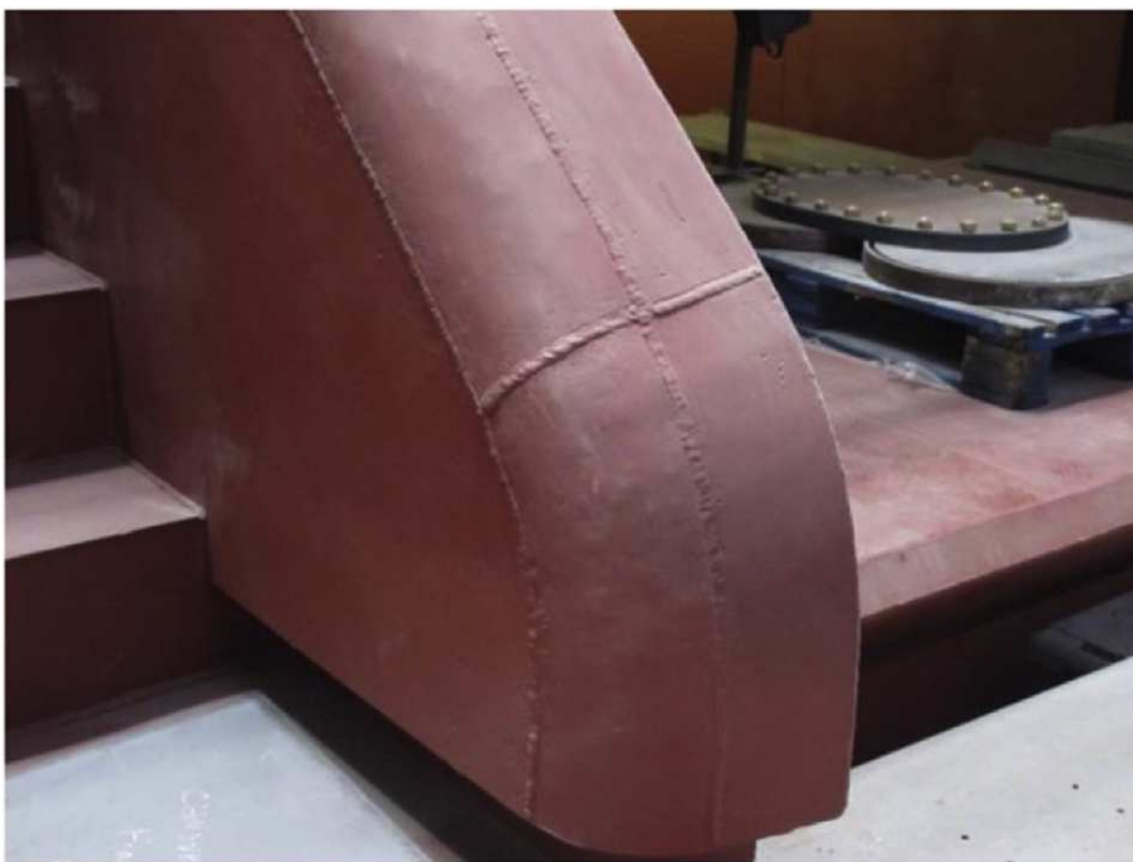
Figura 5.3.2 Segni evidenti di saldatura negli scafi. [9]
