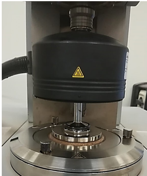
Figura 26 Piatto superiore nella posizione di misura e schiacciamento del bitume
