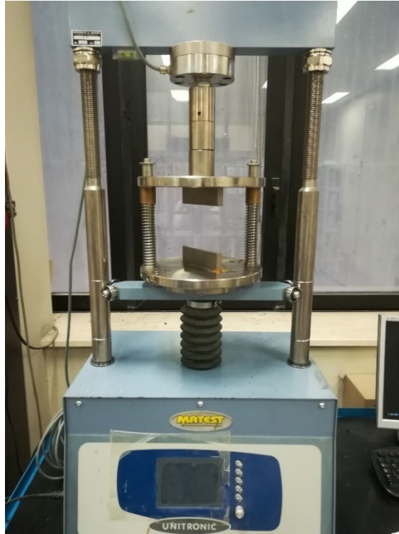
Figura 18 Apparecchiatura utilizzata per la prova ITS
