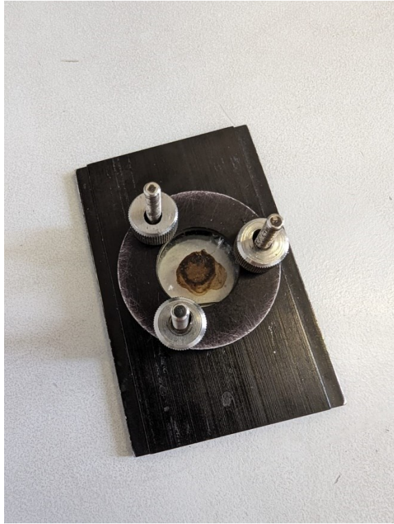
Figura 32 Posizionamento del campione nel comparto cella
