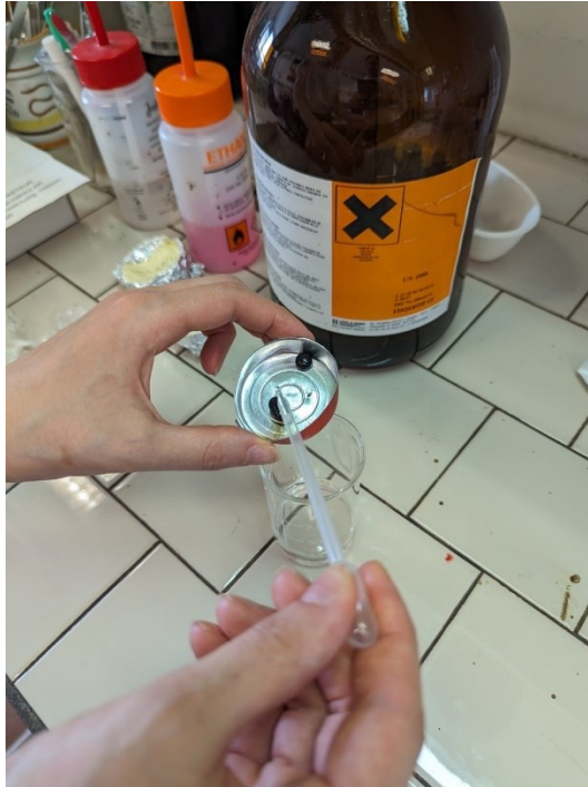
Figura 30 Fluidificazione del bitume con cloroformio
