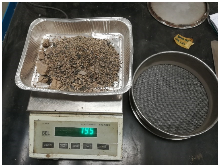
Figura 12 Pesatura del materiale trattenuto nei setacci
