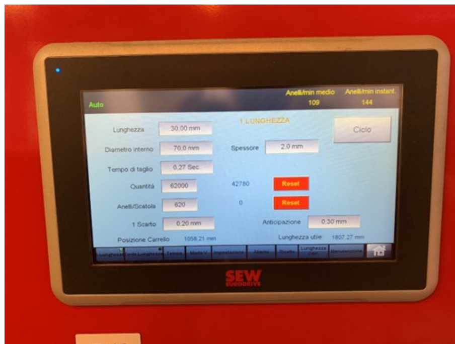
Figura 51: Ricezione parametri macchina impostati da SW gestionale su display di controllo
