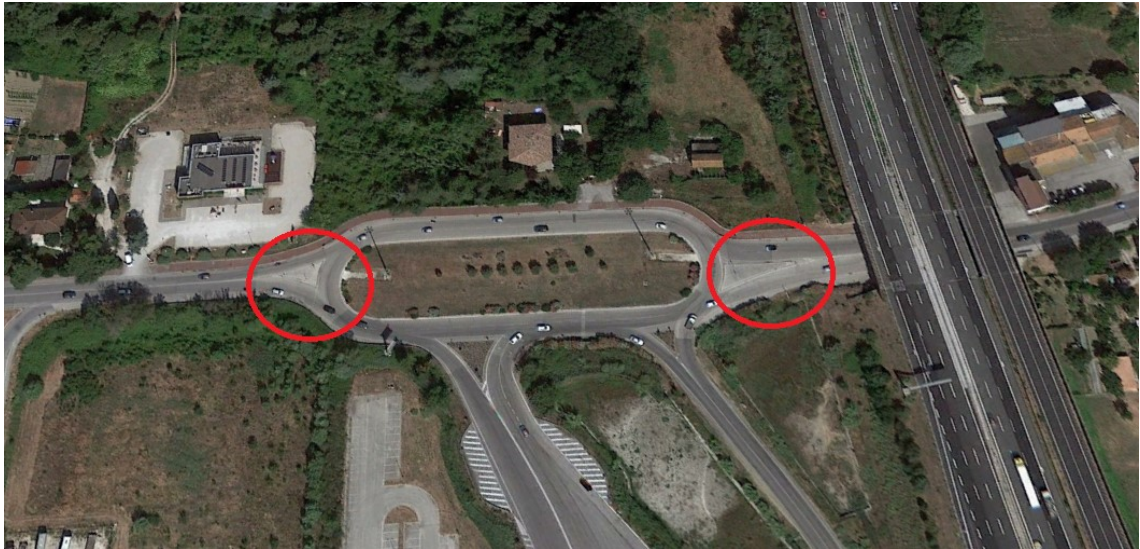
Figura 25. L'immagine rappresenta la rotatoria vista dall'alto; segnalati in rosso i due ingressi allo snodo resi critici dalla presenza di vegetazione in punti sensibili.
