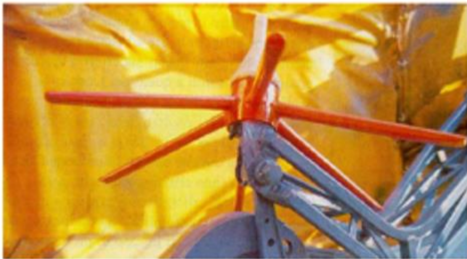
Figura 12: Elemento a stella della vendemmiatrice a scuotimento verticale
