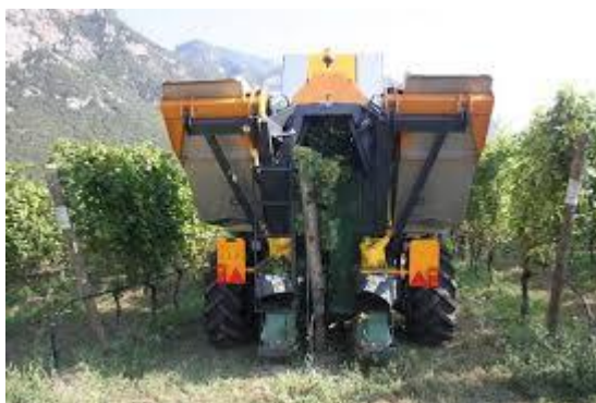
Figura 9: Vendemmiatrice a scuotimento orizzontale (fonte: www.agraria.org )
