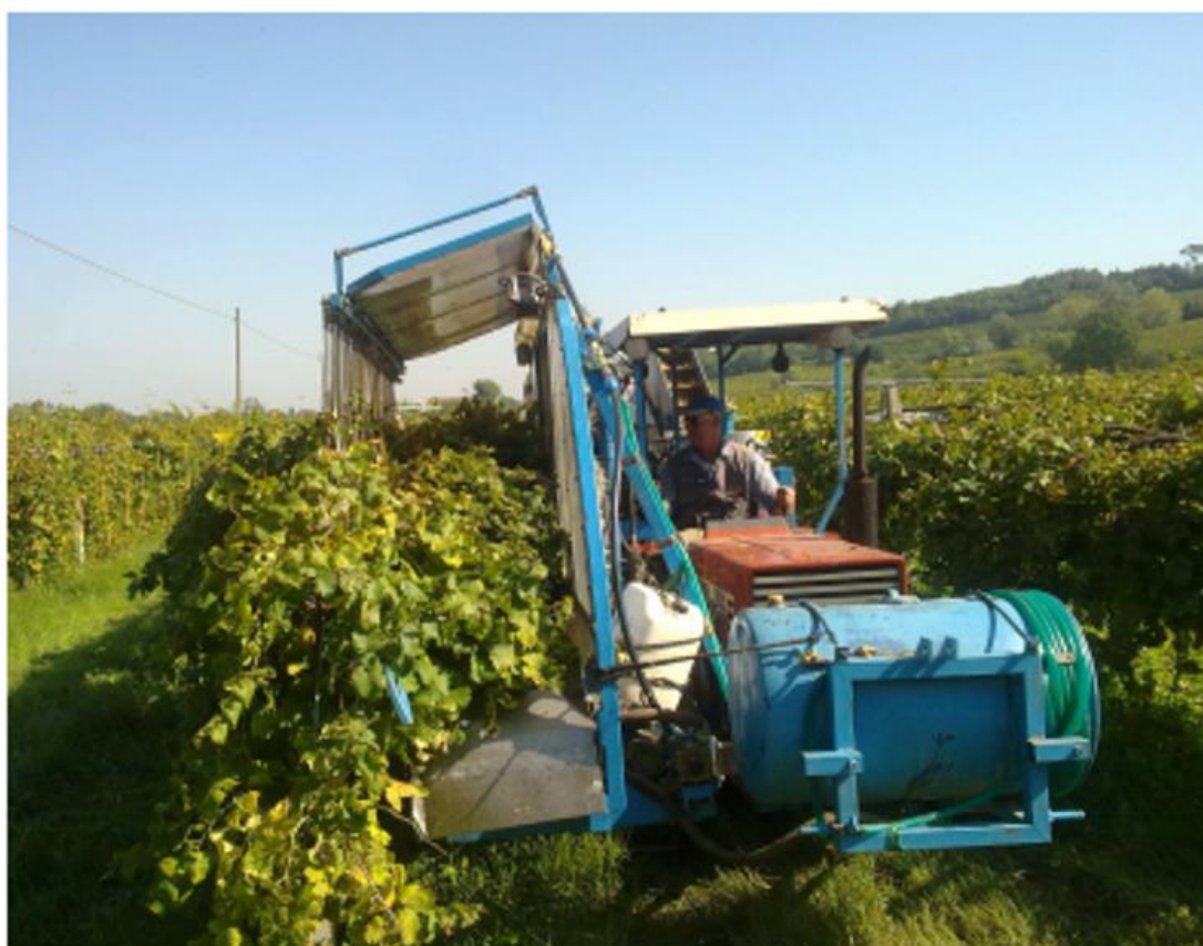
Figura 11: Vendemmiatrice a scuotimento verticale (fonte: www.agraria.com )
