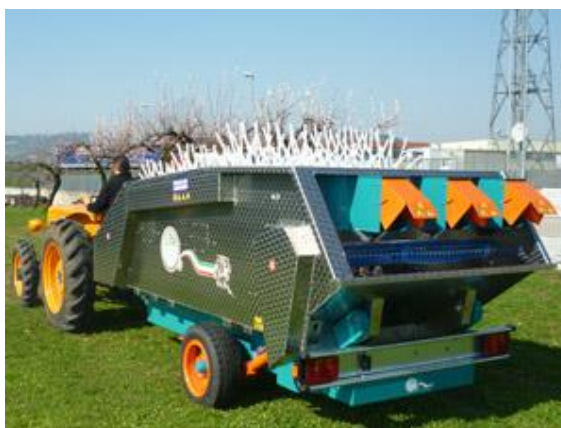
Figura 13: Vendemmiatrice per tendone (fonte: www.costruzionicrm.it )
