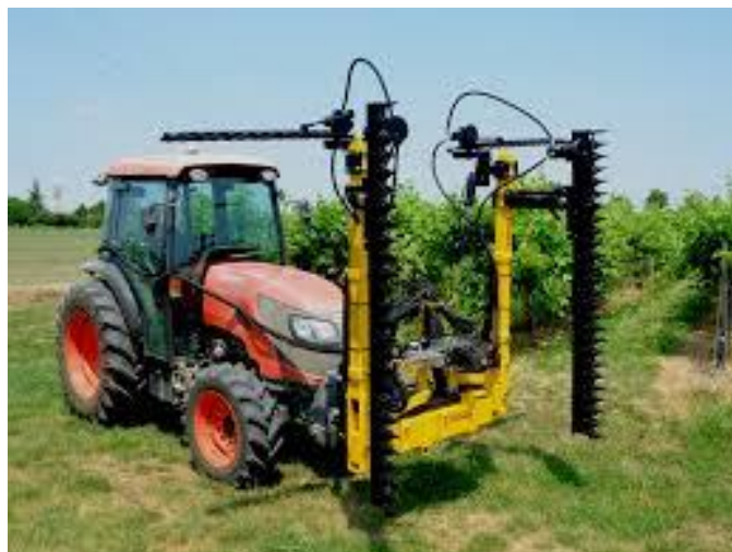
Figura 15: Potatrice a barre falcianti (fonte: www.tecnovict.com )
