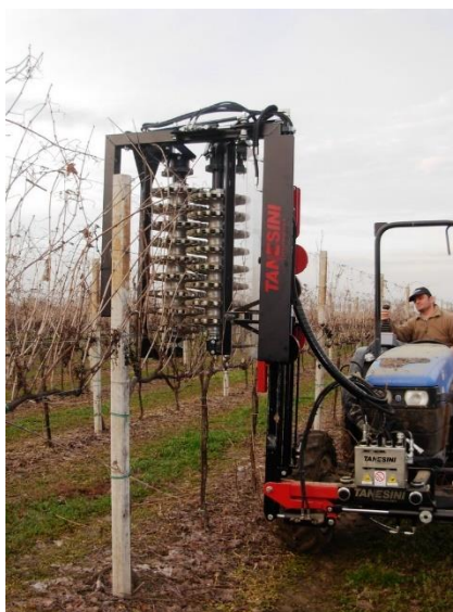
Figura 16: Potatrice a dischi rotativi (fonte: www.allvineyard.it )
