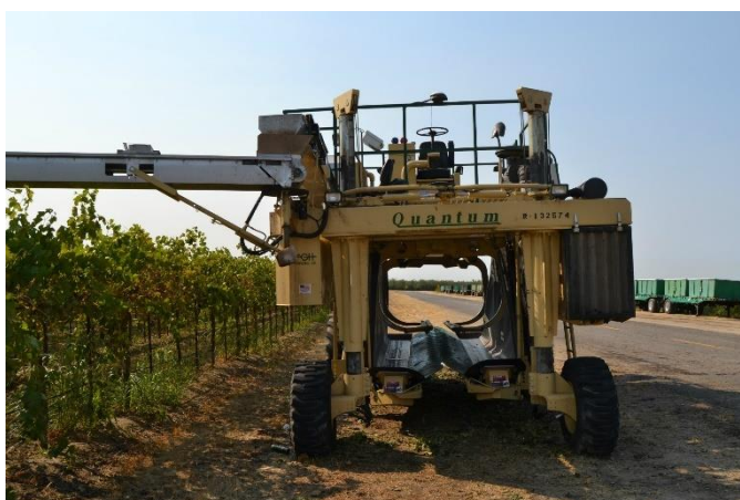
Figura 14: Vendemmiatrice a scuotimento trasversale (fonte: www.georgofili.com )
