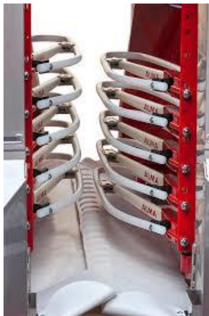
Figura 10: Esempio di una serie di battitori della casa costruttrice Alma (fonte: www.alma-france.com )
