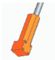
Figura 21 -SUPPORTO VITE - COLONNA MAGGIORATA (arancione)
