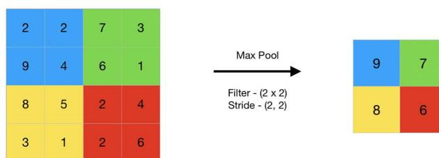
Figura 2.4: Strato di Max pooling applicato alla feature map. Filtro di dimensione 2x2 e passo 2. [14]
