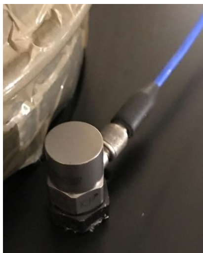
Figura 4.8 Dettaglio di un accelerometro monoassiale – base di montaggio
