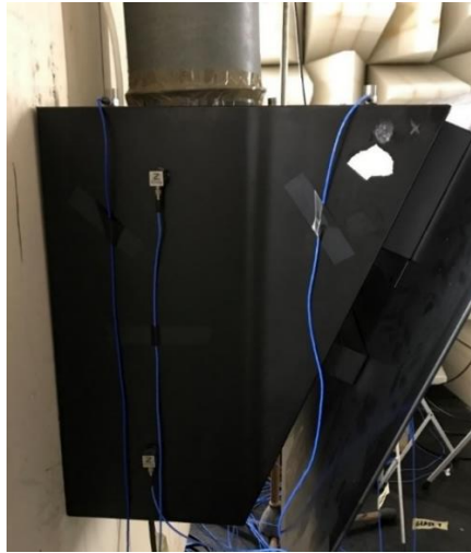
Figura 4.12 Setup accelerometri – Box
