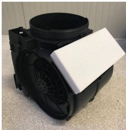
Figura 3.14 Configurazione 4: pannello in melamina da 2 cm applicato sul diffusore
