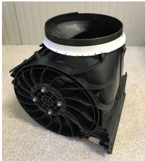
Figura 3.15 Configurazione 6: nastro in gomma da 0,4 mm sul collarino
