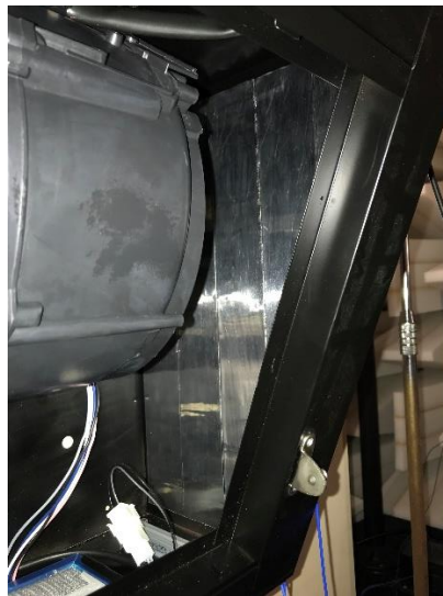
Figura 3.17 Configurazione 8: melamina e nastro in alluminio applicati sul Box
