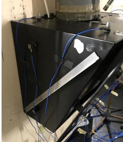
Figura 3.16 Configurazione 7: irrigidimento con staffe in acciaio
