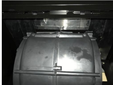
Figura 3.18 Configurazione 9: melamina e nastro in alluminio applicati sul Top
