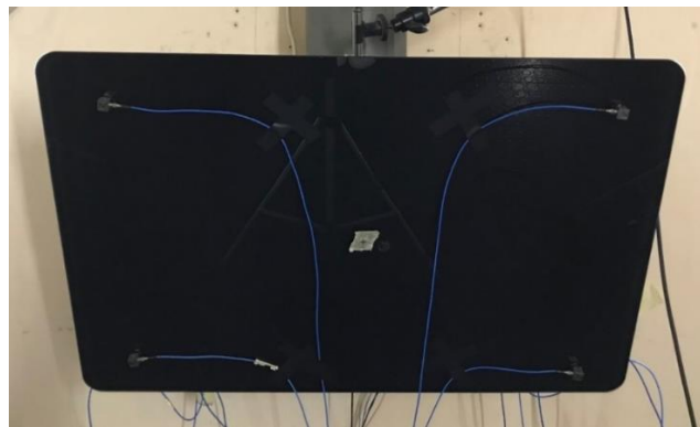
Figura 4.13 Setup accelerometri - Glass
