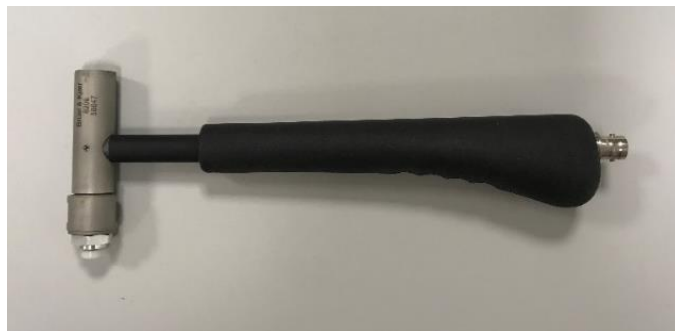
Figura 4.17 Martello strumentato, B&K tipologia 8206
