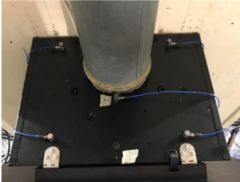
Figura 4.9 Setup accelerometri – top
