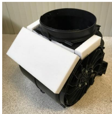
Figura 3.19 Configurazione 11: melamina sul Box e sul diffusore
