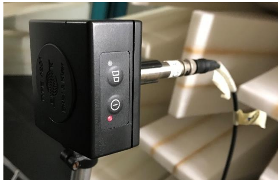
Figura 5.8 Calibratore acustico, B&K tipologia 4231
