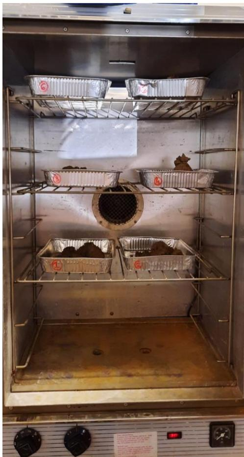
*Figura 4.2.15 Provini inseriti in forno a 105° per 24 ore*
