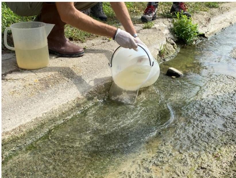
*Figura 4.2.9 Versamento della soluzione salina nel torrente*
