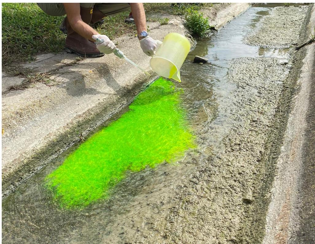
*Figura 4.2.7 Immissione del tracciante nel corso d'acqua*
