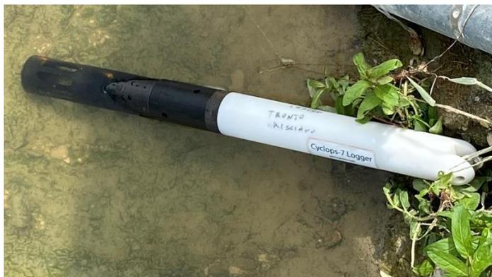
*Figura 4.1.14 Sonda fluorimetrica utilizzata per le misure di portata con tracciante*
