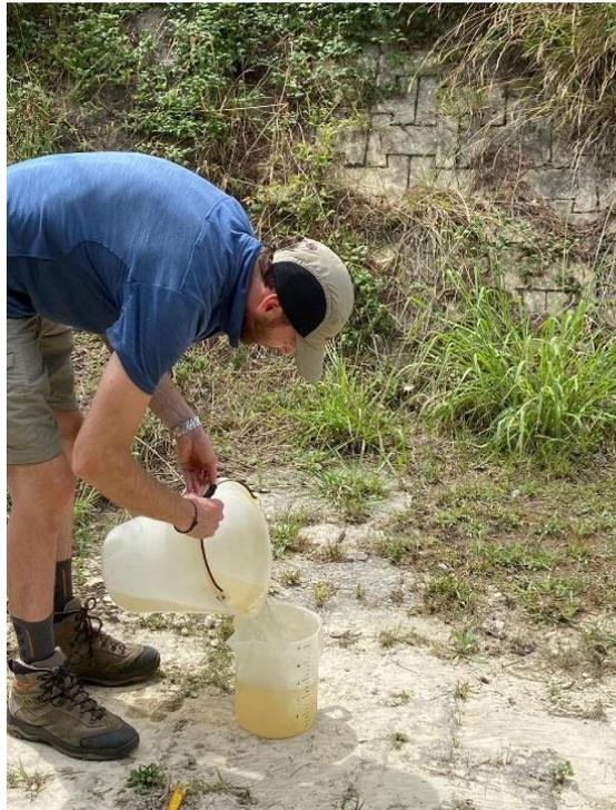
*Figura 4.2.3 Misura del volume di acqua*
