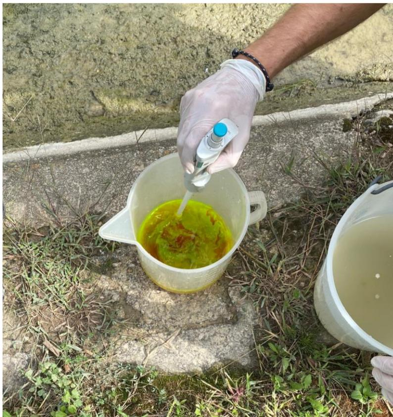
*Figura 4.2.6 Miscelazione della fluoresceina in acqua di fiume*
