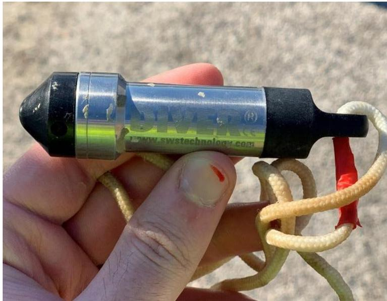
*Figura 4.1.11* Trasduttore di pressione con datalogger interno per la registrazione dei dati
