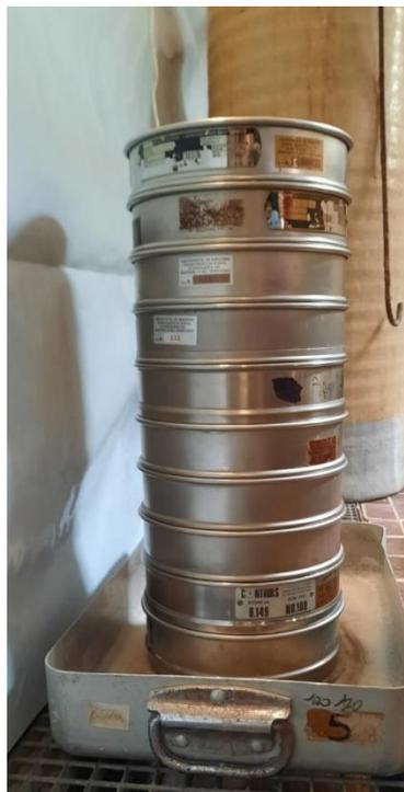
*Figura 4.1.3 Pila di setacci per la prova granulometrica*
