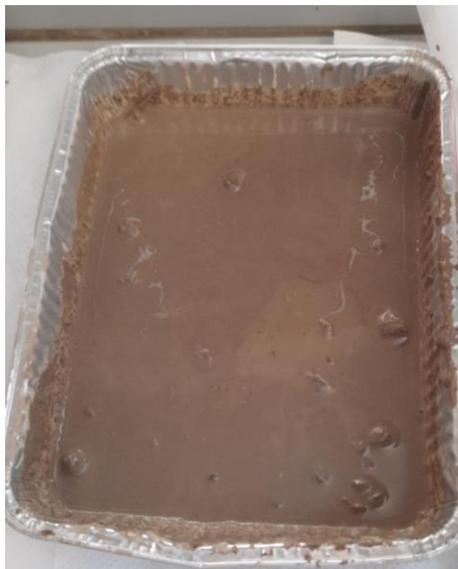
*Figura 4.2.17* Campione di terreno sciolto con sodio esametfosfato
