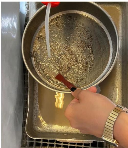
*Figura 4.2.18 Lavaggio del trattenuto di un setaccio mediante spruzzino, con ausilio di una spatola*
