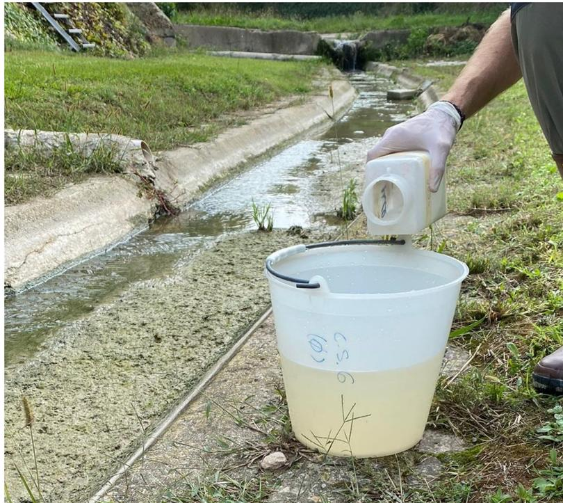
*Figura 4.2.8 Miscelazione del Cloruro di Sodio con acqua del fiume*
