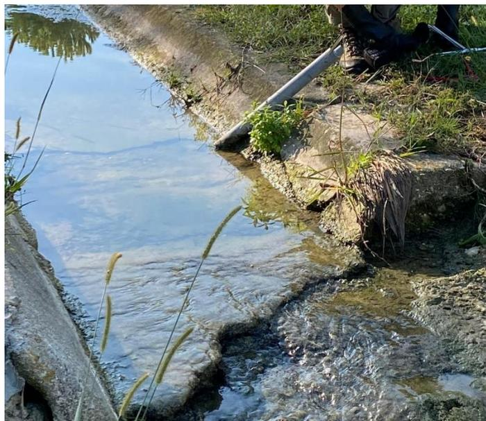
*Figura 5.5.1 Posizione del sensore per il livello idrometrico, nel Torrente di Vallemiano*
