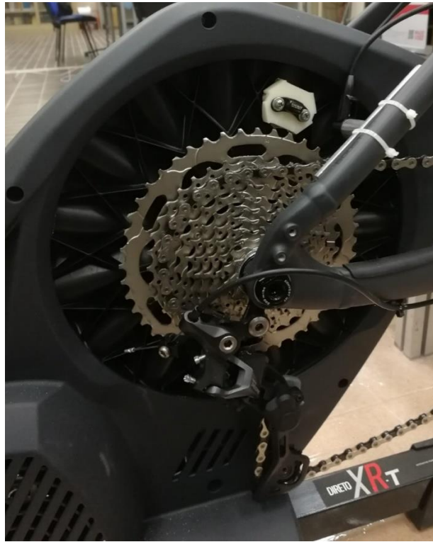
Figura 2.5 – Supporto per il magnete sul volano di Elite Direto XR-T e per il sensore di velocità
