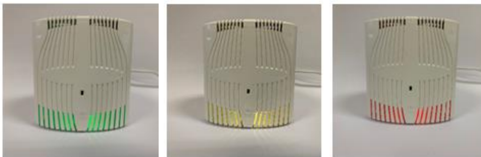
Figura 2.8: LED a colori per la comunicazione all'utente del livello di qualità dell'aria
