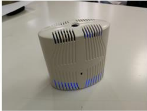
Figura 2.5: Nodo per le misurazioni ambientali del Comfort Eye
