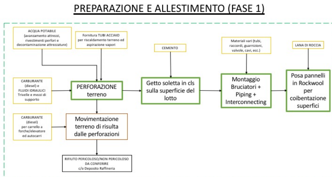
Figura 7.3: Confini del sistema Preparazione e Allestimento (Fase 1)
