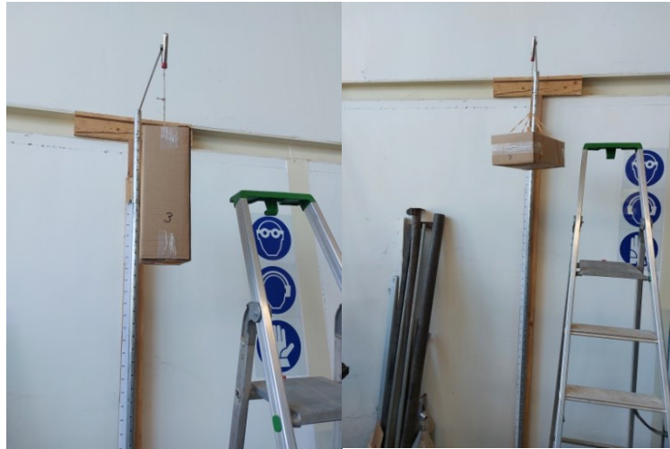
Figura 2-3: Dispositivo per prove d'urto verticale con impatto sulla faccia 1 (a sinistra) e 2 (a destra)
