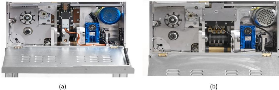
Figura 2.3: Teste di reggiatura Messersì. [1]
