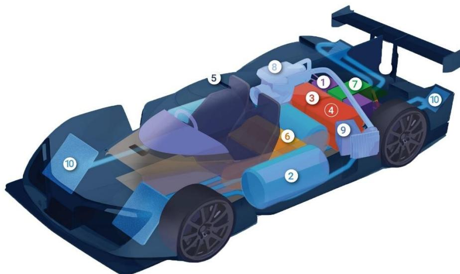
**Figura 1.1.** Struttura interna del prototipo LMPH2G. Sono visibili i tre serbatoi: due ai lati dell'abitacolo, uno dietro ad esso.
