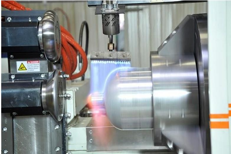
**Figura 2.11.** Esempio di processo di *hot metal spinning*, con il quale si ottiene la seconda calotta del *liner*.
