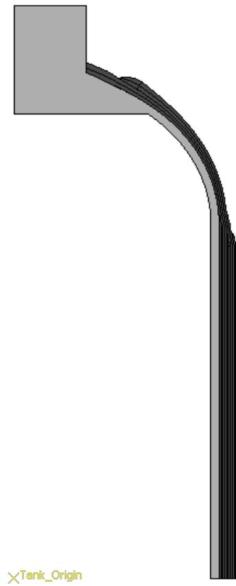
**Figura 3.19.** Geometria complessiva del serbatoio in composito.
