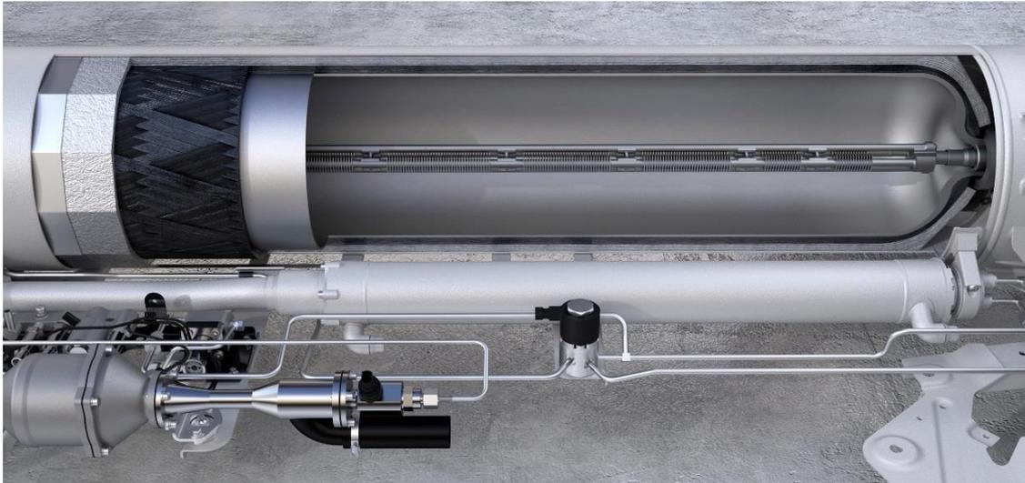
**Figura 2.4.** Serbatoio per idrogeno crio-compresso (BMW [40]).
