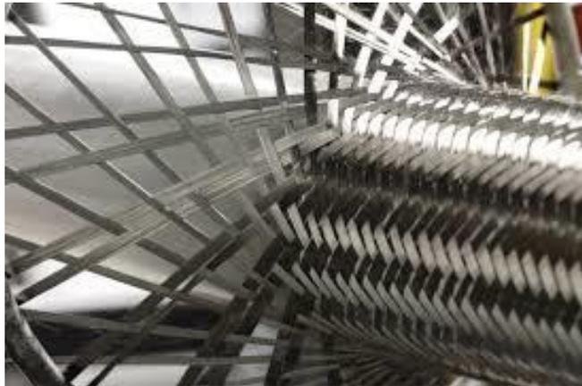
**Figura 2.21.** Tessitura realizzata attraverso la tecnica di *braiding* (sito web Cristex Composite Materials)
