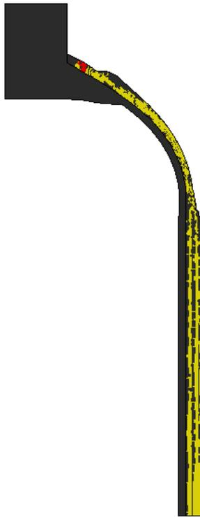
**Figura 3.30.** Danneggiamento nel serbatoio con pressione interna pari a 125 MPa.
