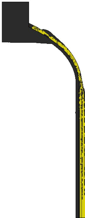
**Figura 3.29.** Danneggiamento nel serbatoio con pressione interna pari a 115 MPa.
