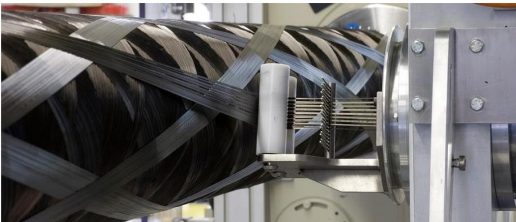
**Figura 2.13.** Esempio di processo di *filament winding* (sito web CONNOVA).
