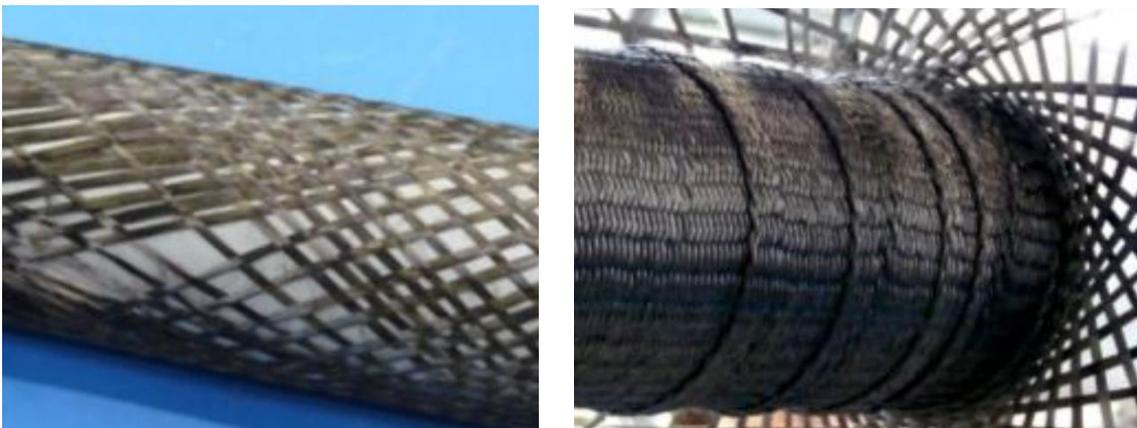
**Figura 2.22 e Figura 2.23.** Difetti legati ad angoli di *braiding* troppo piccoli (sinistra) o troppo elevati (destra) [32].
