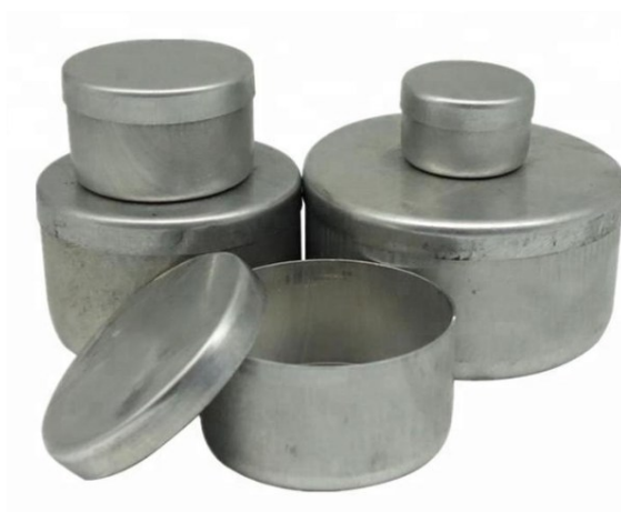
Figura 26, contenitori per la misura del contenuto d'acqua 59
