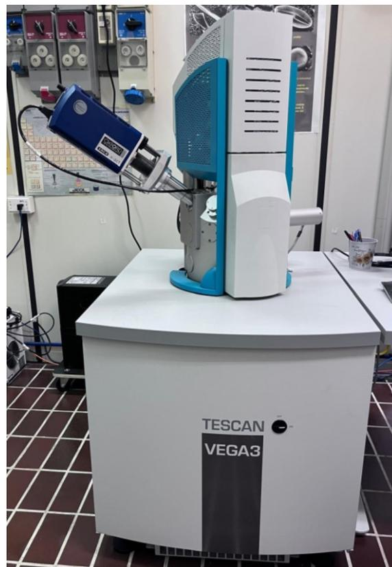
figura 5.1, Microscopio elettronico a scansione (SEM)
