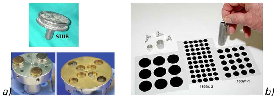
figura 5.5 (a), stub; figura 5.5 (b), adesivo per stub [25]
