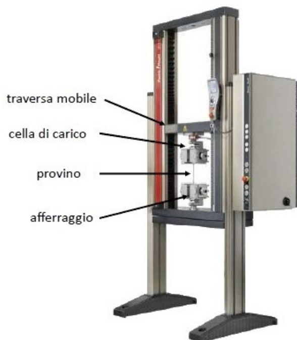
Figura 10: Macchina di trazione
