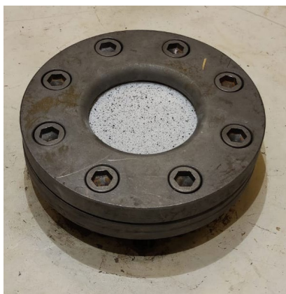
Figura 28: Provino posizionato sulle flange per le prove biassiali di bulge test
