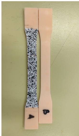
Figura 20: Speckle sui provini
