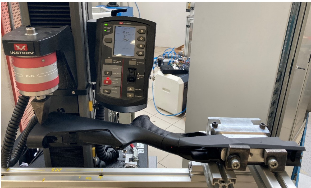
Figura 3-10: Esempio di prova di flessione calcio di serie in configurazione F6
