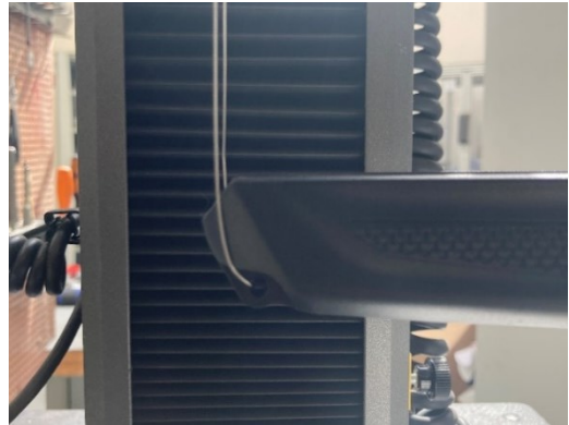
Figura 3-13: Particolare del cavo di acciaio passante per il foro porta bretella
