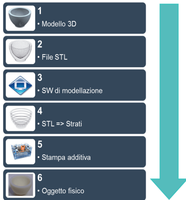
Figura 2-1: Iter produttivo dell'additive manufacturing (7)
