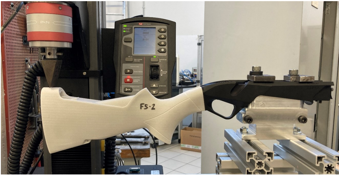
Figura 3-11: Esempio di prova di flessione calcio AM in configurazione F4
