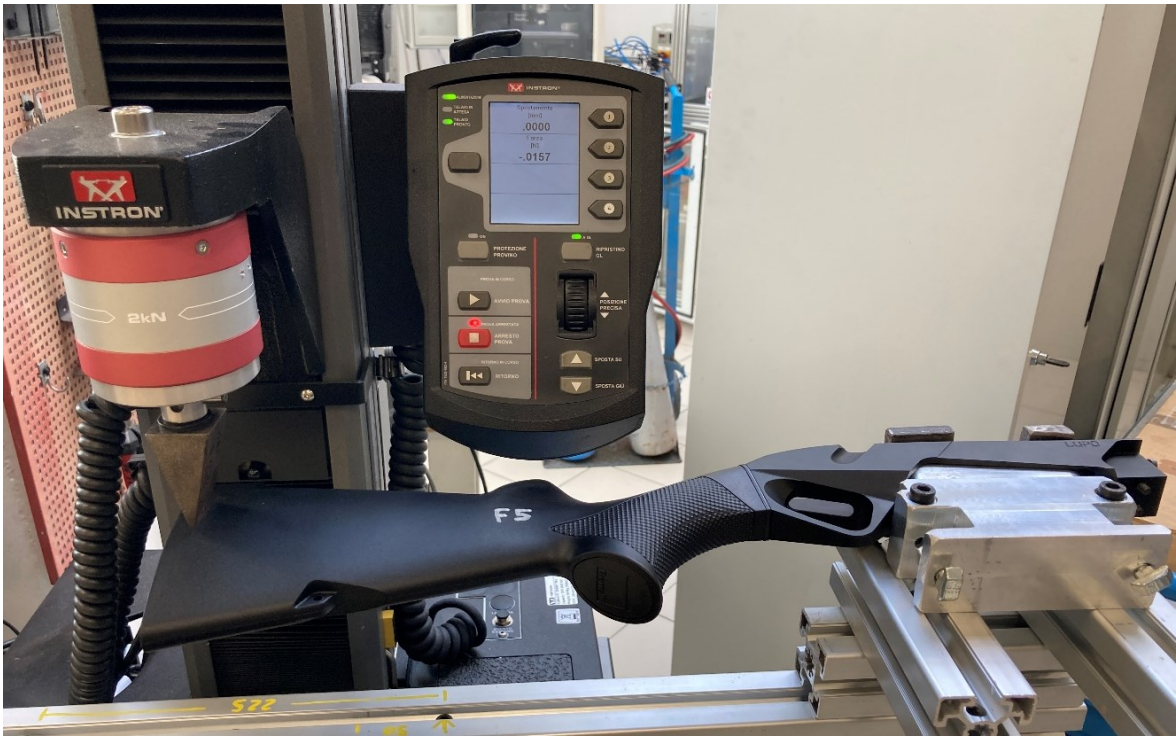
Figura 3-9: Esempio di prova di flessione di un calcio di serie in configurazione F5
