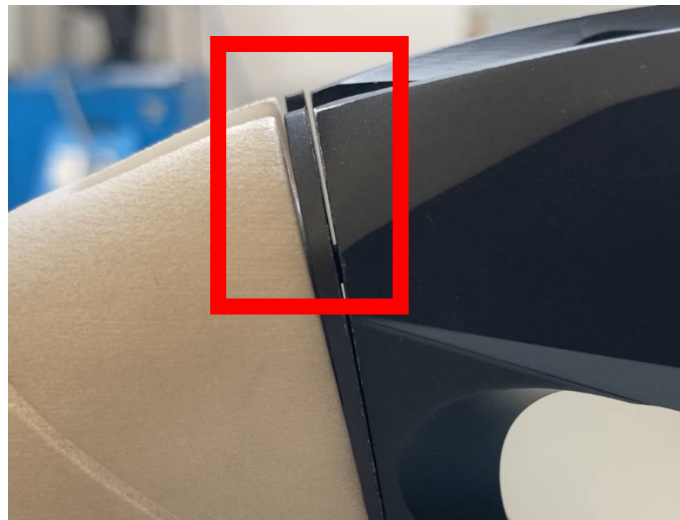
Figura 4-22: La figura mostra l'incastro non perfetto tra carcassa e calcio
