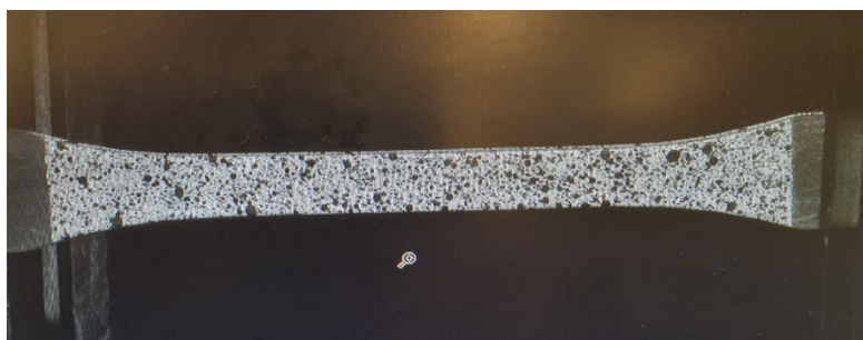
Figura 21-Rappresentazione del procedimento di ottenimento dello speckle
