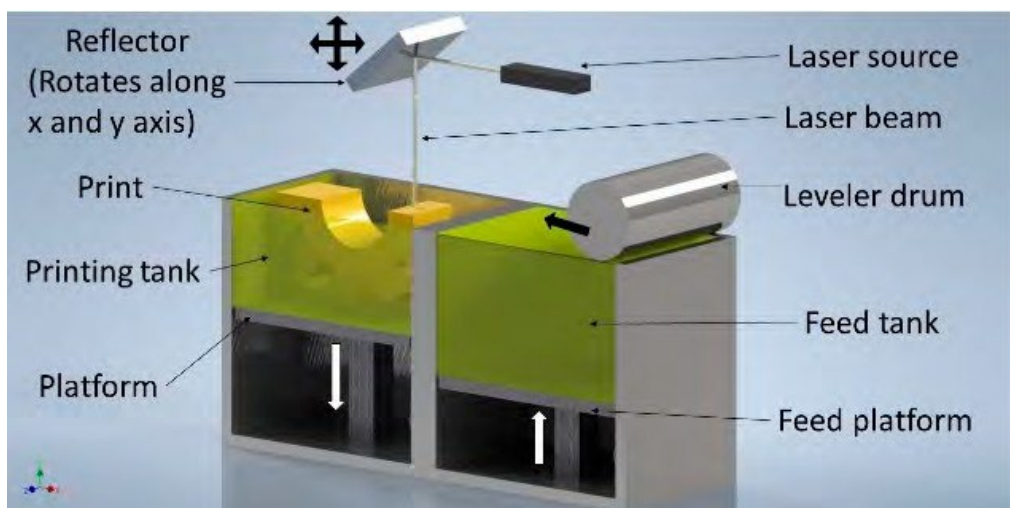
Figura 7- Rappresentazione processo di produzione SLS [13]
