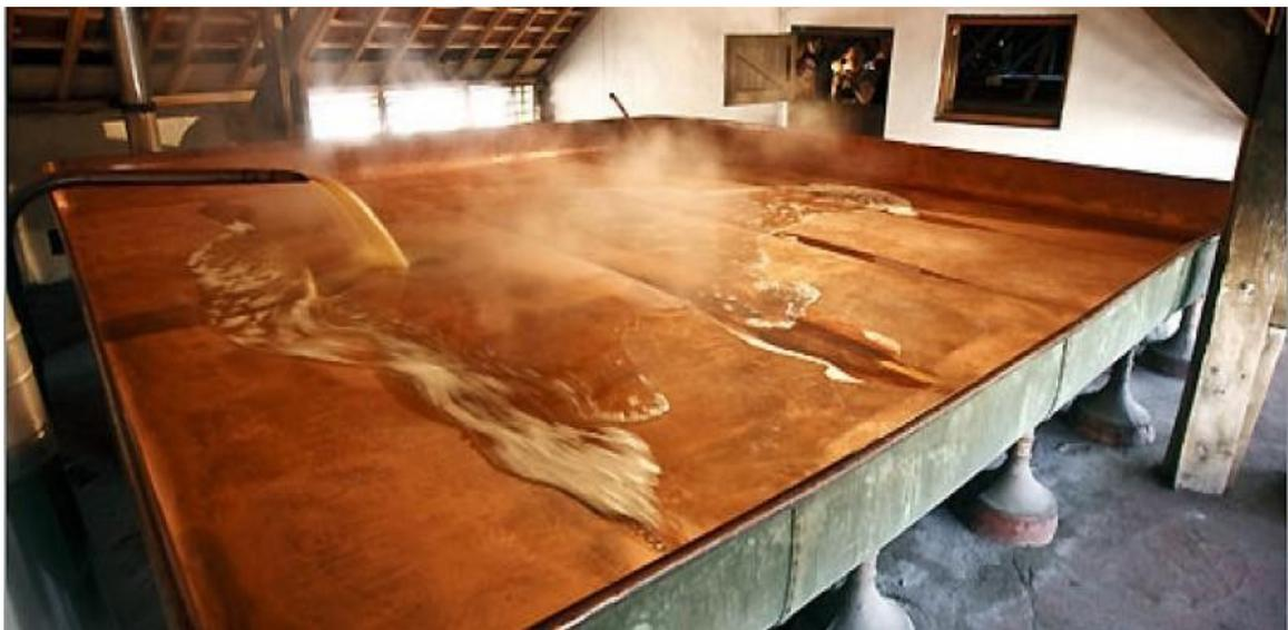
Figura 4-2: Immissione del mosto caldo in una vasca aperta di raffreddamento. Da notare la finestra adiacente ad essa, che deve rimanere aperta fino alla fine del processo.
