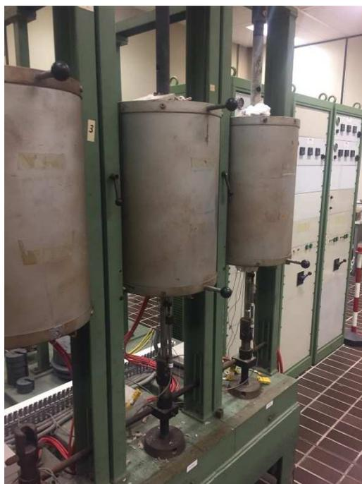
**Figura 6** – macchina per prova creep
