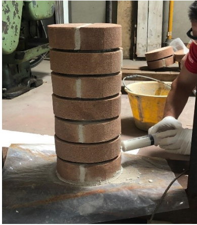
Figura 3.75 Applicazione strato di allettamento di resina e aggancio della corda al telaio fisso.
