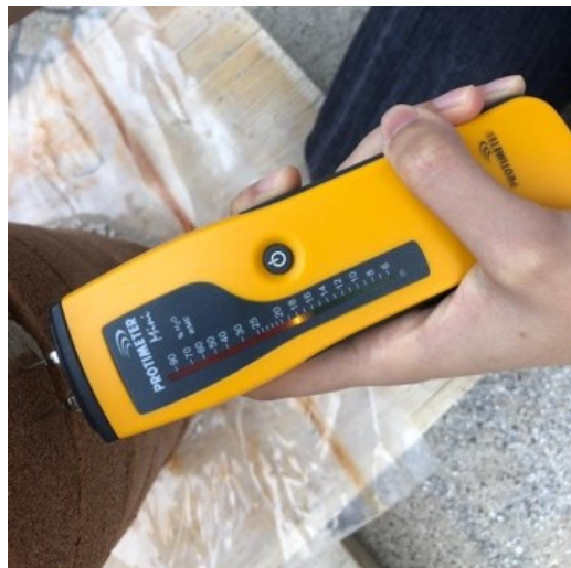
Figura 3.68 Misurazione contenuti d'acqua
