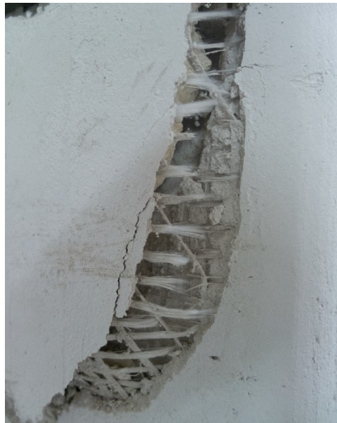
Figura 2.24 Dettaglio della rottura della griglia in fibra all'angolo. [28]
