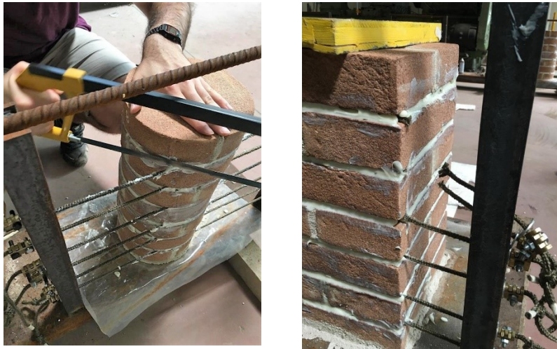
Figura 3.78 Taglio delle corde e rimozione della colonna dal telaio.
