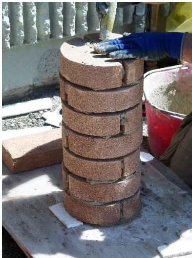
Figura 3.41 Colonna senza riempimento giunti esterni.
