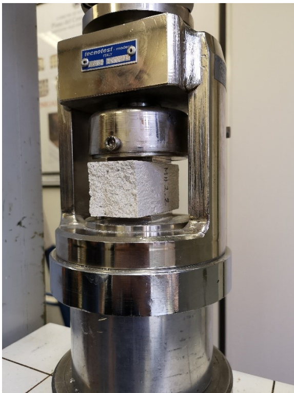
Figura 3.17 Prova a compressione sul provino di malta MII 2.2.
