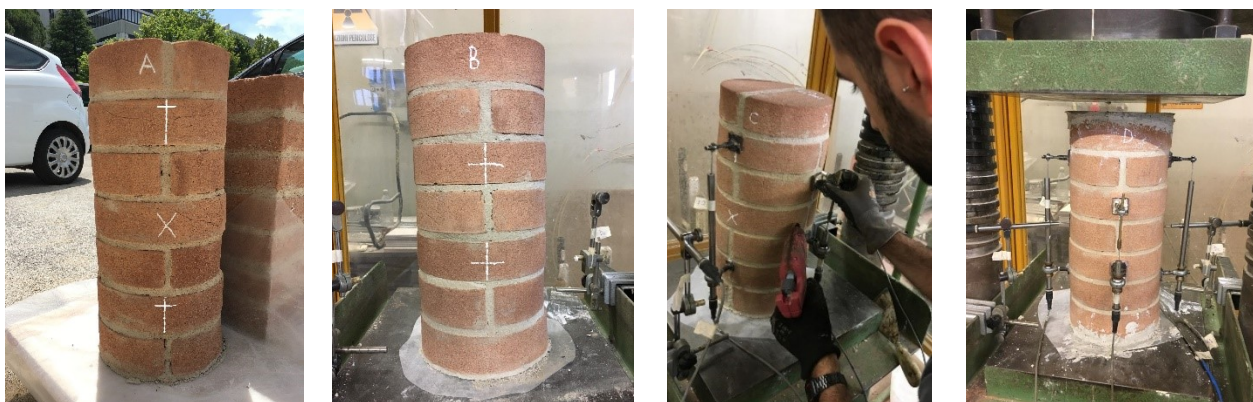
Figura 3.80 Posizionamento dei trasduttori sulle colonne.
