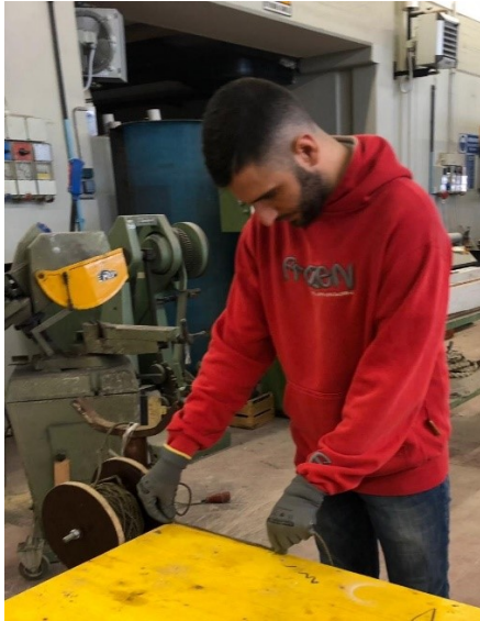
Figura 3.65 Misurazione lunghezza e taglio delle corde di basalto.
