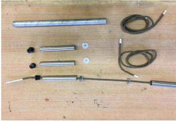
Figura 3.28 Componenti del provino e assemblaggio provvisorio.
