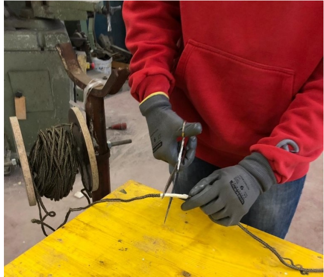
Figura 3.65 Misurazione lunghezza e taglio delle corde di basalto.
