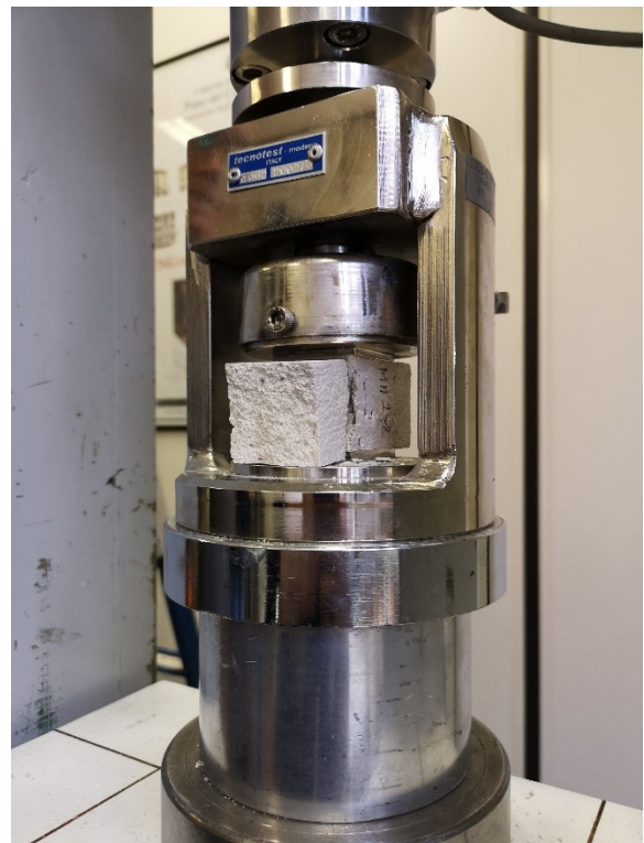
Figura 3.17 Prova a compressione sul provino di malta MII 2.2.
