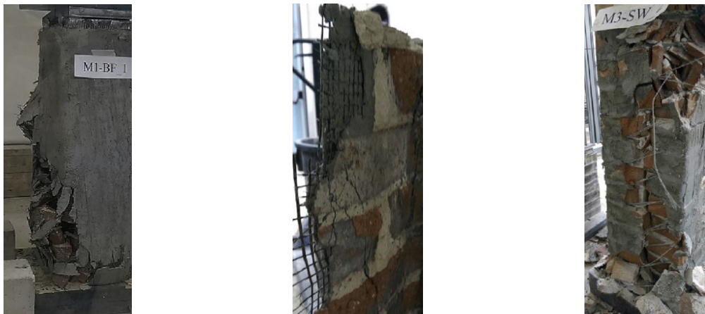
Figura 2.21 Modalità di guasto (da sinistra): 1. Confinato con FRP; 2. Confinato con BFRCM; 3. Confinato con fili di acciaio. [23]
