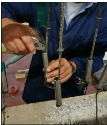
Figura 3.29 Colatura della resina epossidica e provini pronti ad essere testati.
