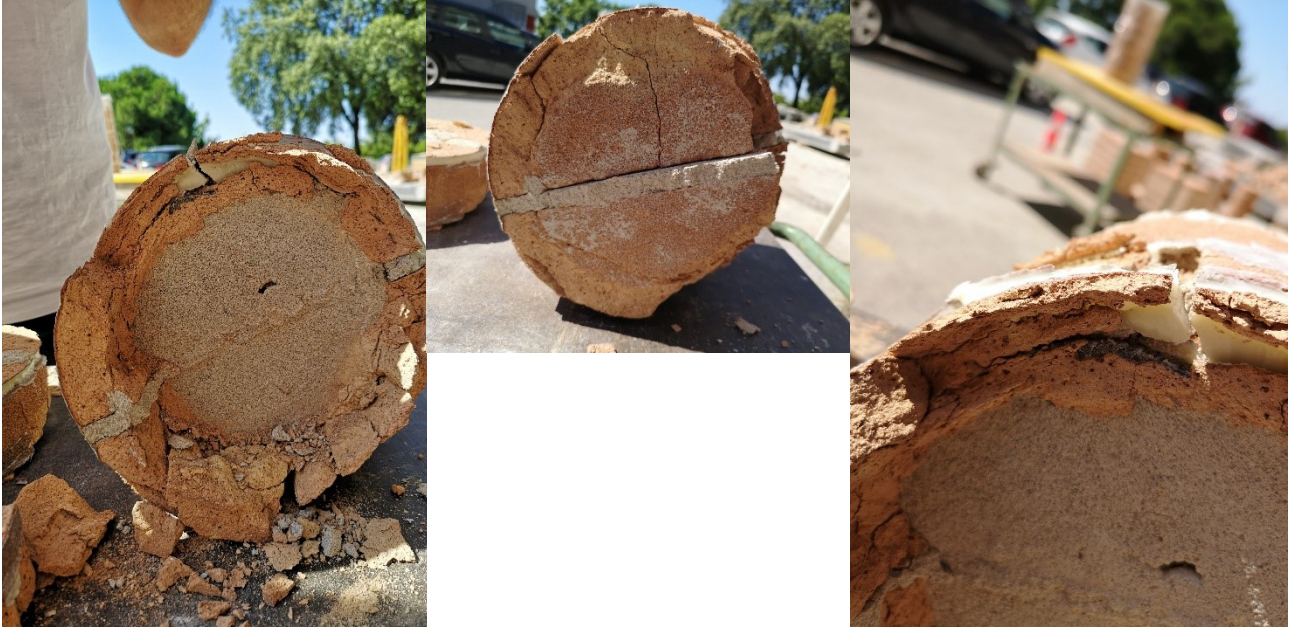
Figura 5.8 Analisi della parte interna della colonna CI PTR 40 3.
