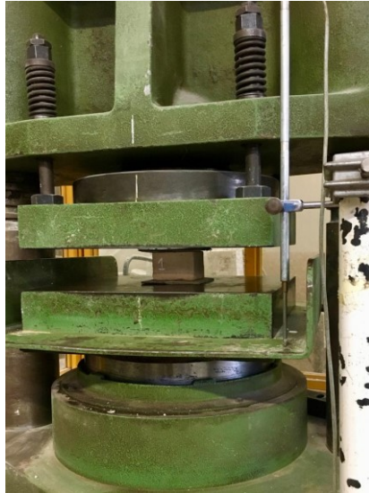
Figura 3.24 Prova a compressione dei campioni di mattoni.
