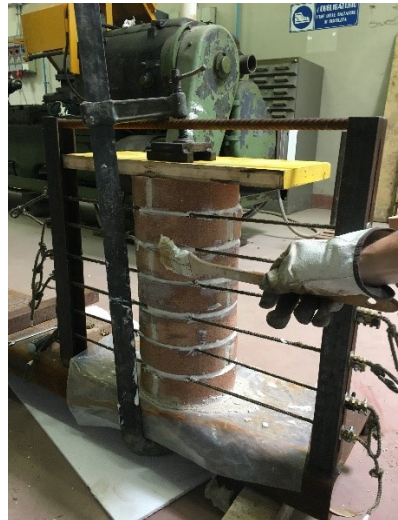
Figura 3.76 Particolare su cella di carico e fuga del giunto con resina.
