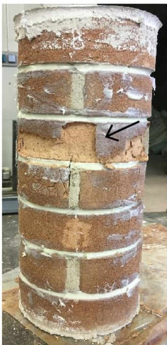
Figura 5.3 Lesione in corrispondenza di B1.
