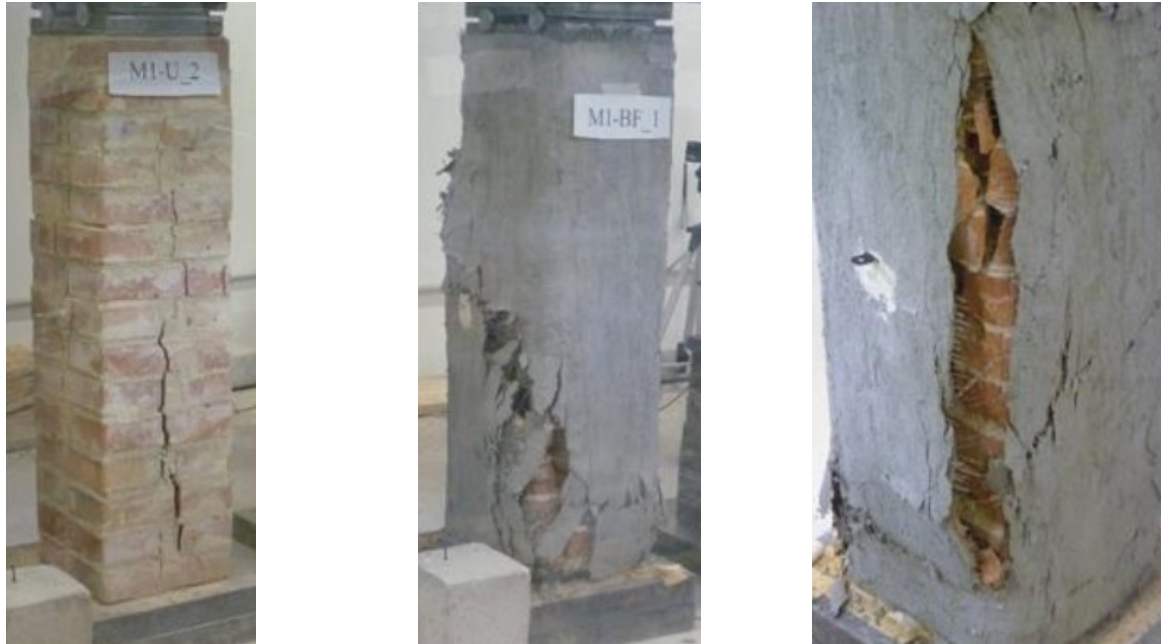
Figura 2.19 Modalità di guasto: 1. Non confinato; 2. Confinato con BFRCC; 3. Frattura a trazione della maglia con fibra di basalto. [22]
