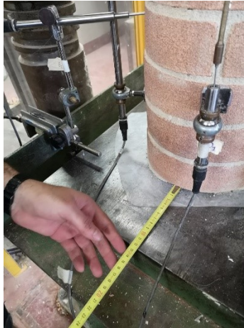
Figura 3.81 Centramento della colonna sotto la macchina di prova.
