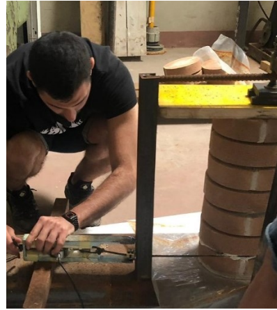
Figura 3.75 Applicazione strato di allettamento di resina e aggancio della corda al telaio fisso.
