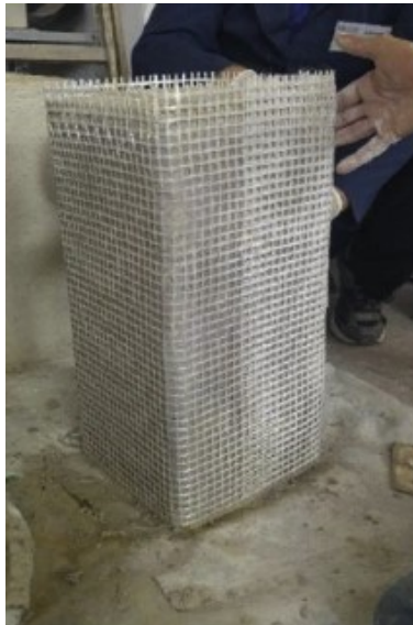
Figura 2.25 Rinforzo in fibra di vetro. [29]
