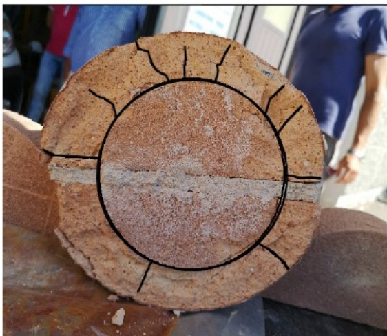
Figura 5.9 Distacco dell'interfaccia e fessure a raggiera.
