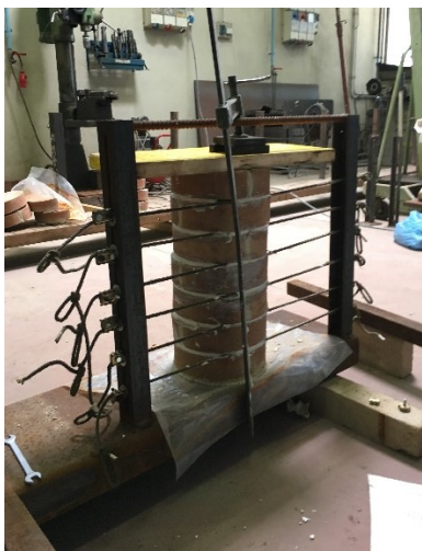
Figura 3.77 Colonna rinforzata con corde pretensionate al 40%.
