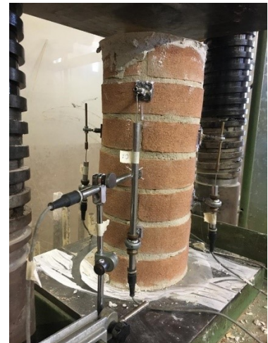
Figura 3.82 Realizzazione della cappa di gesso, posizionamento di un foglio di nylon, colonnina pronta per la prova.
