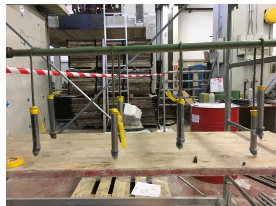
Figura 3.29 Colatura della resina epossidica e provini pronti ad essere testati.
