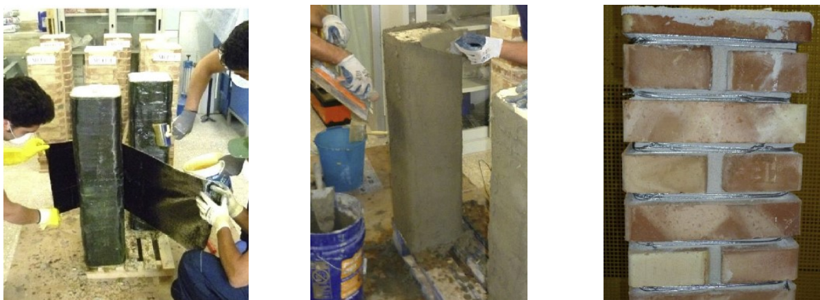
Figura 2.20 Preparazione dei campioni (da sinistra): 1. Confinato con FRP; 2. Confinato con BFRCC; 3. Confinato con fili di acciaio. [23]
