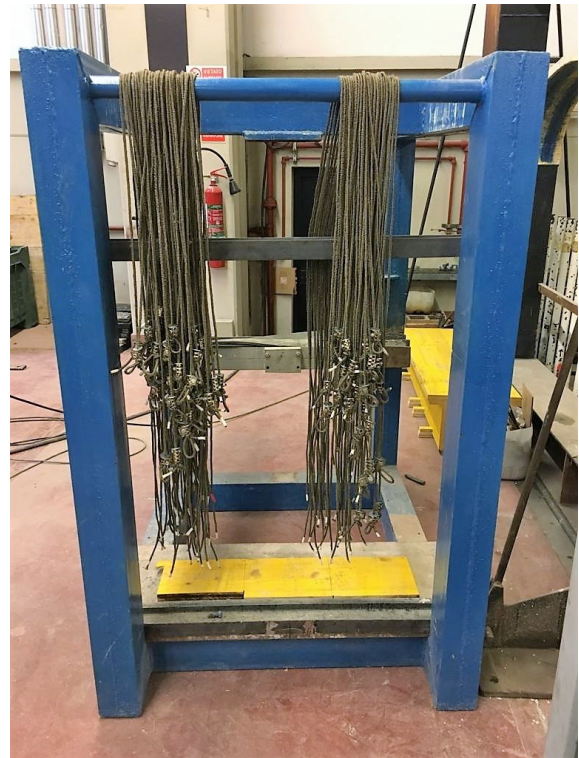
Figura 3.67 Corde pronte per il repointing.
