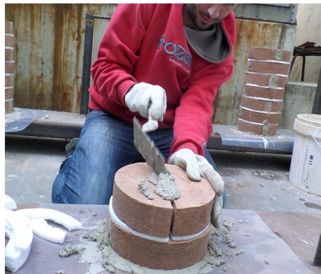
Figura 3.48 Riempimento con malta giunto verticale.
