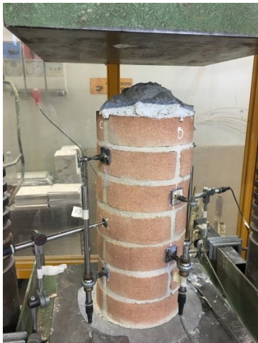
Figura 3.82 Realizzazione della cappa di gesso, posizionamento di un foglio di nylon, colonnina pronta per la prova.
