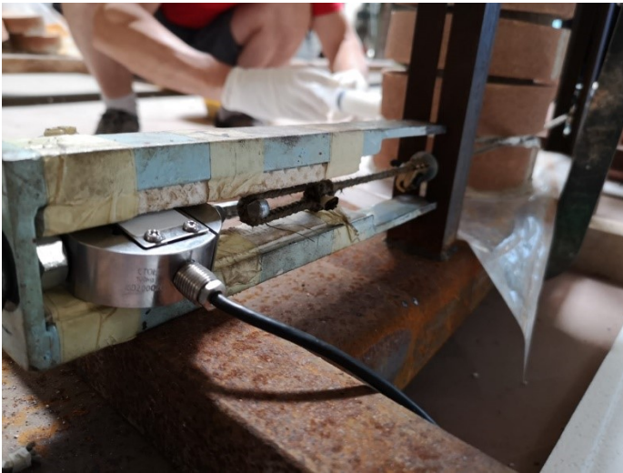
Figura 3.76 Particolare su cella di carico e fuga del giunto con resina.
