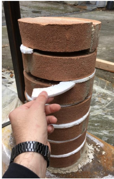
Figura 3.53 Rimozione prismi di polistirene.
