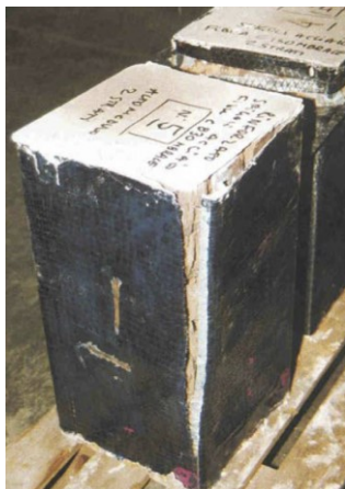
Figura 2.10 Guasto ai bordi del rinforzo. [9]
