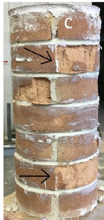
Figura 5.4 Lesione in corrispondenza di C1.
