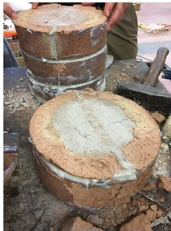
Figura 5.11 Analisi della parte interna della colonna CI PTR 40 5.
