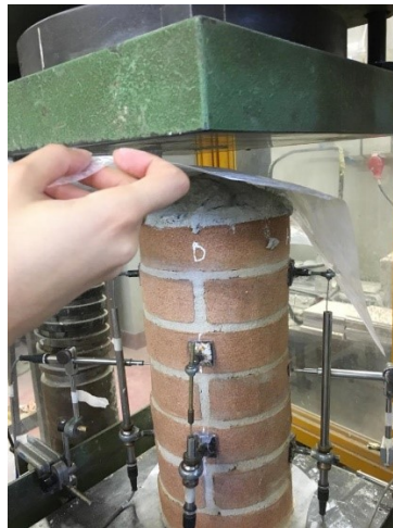
Figura 3.82 Realizzazione della cappa di gesso, posizionamento di un foglio di nylon, colonnina pronta per la prova.
