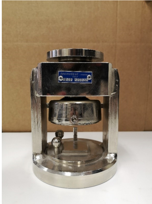
Figura 3.16 Adattatore per prova a compressore con piastra 40x40 mm.
