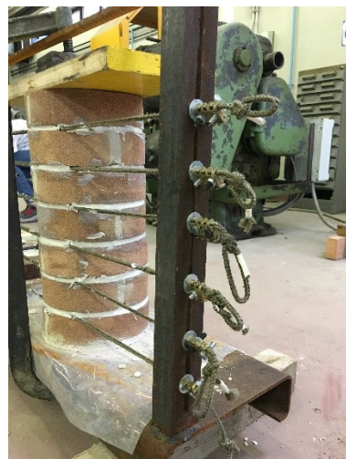
Figura 3.77 Colonna rinforzata con corde pretensionate al 40%.
