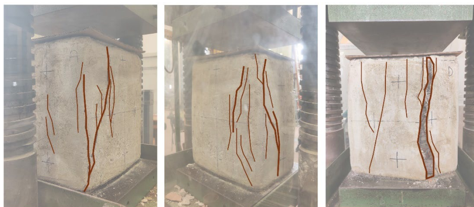
Figura 124_ formazione di fessure verticali e apertura del rinforzo (RT FRCM_3)
