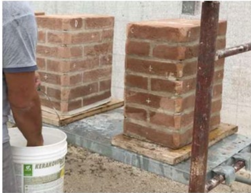
Figura 69_bagnatura della muratura e stesura del primo strato di geocalce
