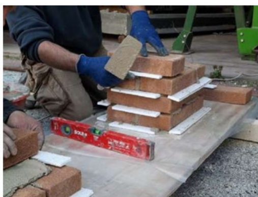
Figura 60_costruzione del provino
