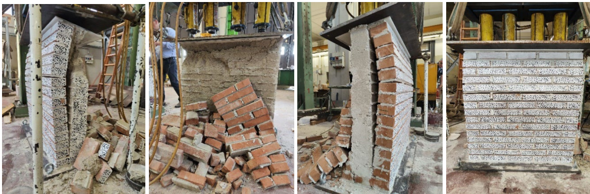
Figura 171_rilievo fotografico in seguito alla prova, facce A, B, C, D (MCS_3)
