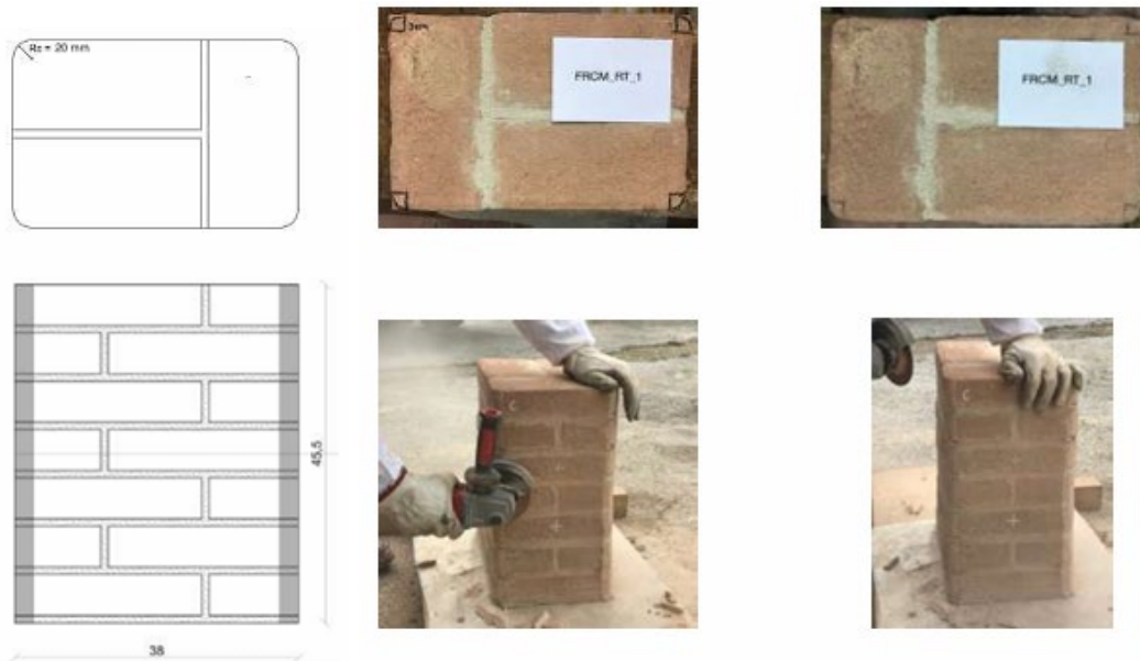
Figura 65_arrotondamento degli spigoli: rappresentazione grafica ed esecuzione
