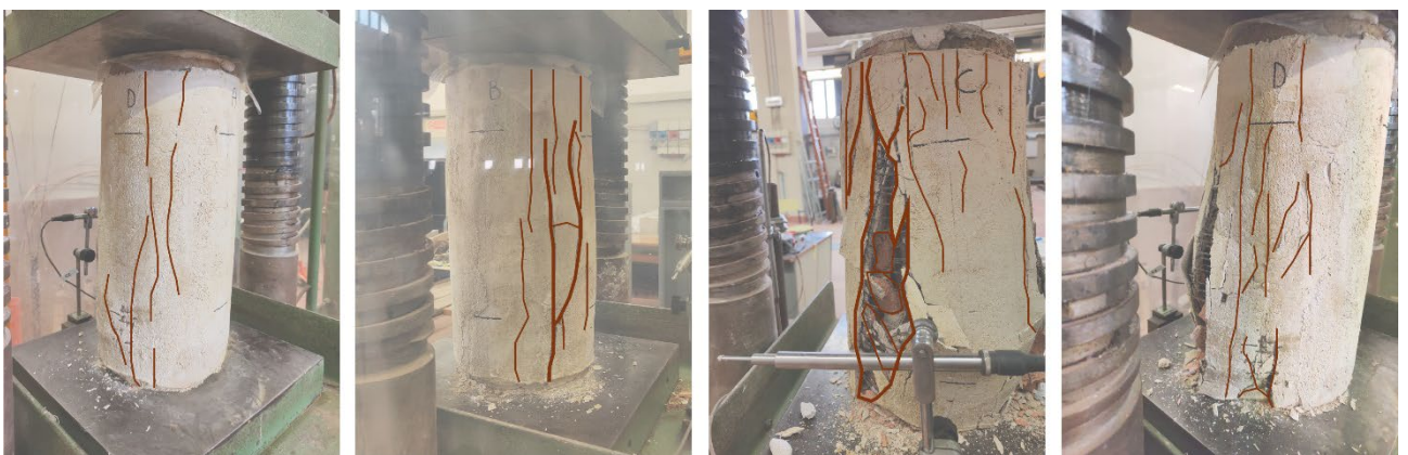
Figura 112_ formazione di fessure verticale e apertura del rinforzo (CI FRCM_3)
