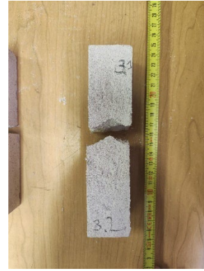
Figura 134_posizionamento del provino sotto la pressa (sx), rottura del provino (dx)
