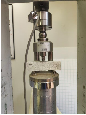
Figura 134_posizionamento del provino sotto la pressa (sx), rottura del provino (dx)
