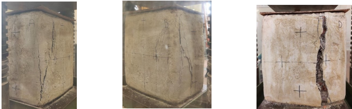
Figura 93_rilievo fotografico in seguito alla prova (RT FRCM_3)
