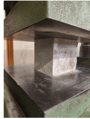
Figura 145_prova a compressione sui cubi di sacco
