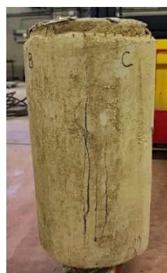
Figura 104_rilievo fotografico in seguito alla prova (CI FRCM_2)
