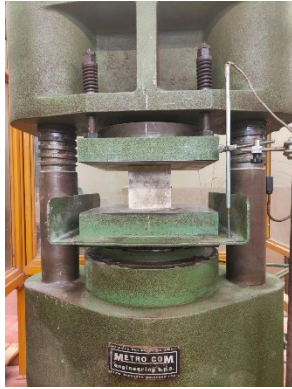
Figura 145_prova a compressione sui cubi di sacco
