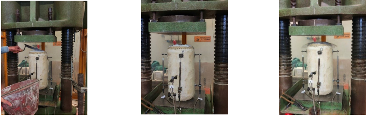
Figura 81_posizionamento della cappa di gesso e del foglio di nylon
