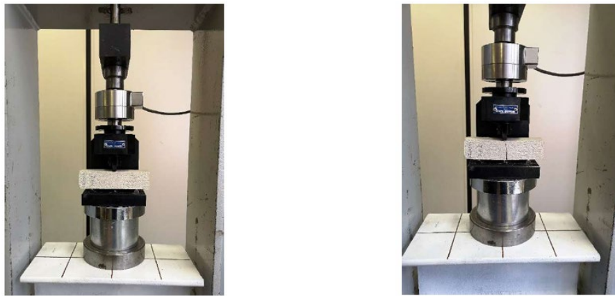
Figura 40_prova a flessione dei provini di malta
