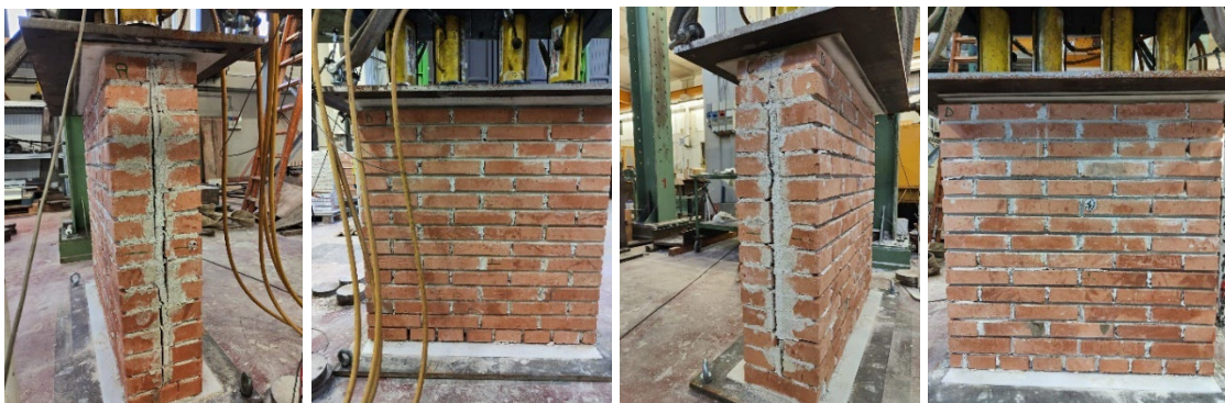
Figura 167_rilievo fotografico in seguito alla prova, facce A, B, C, D (MC_2)
