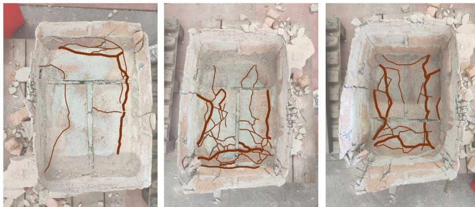
Figura 119_ formazione del nucleo compresso all'interno della sezione (filari 6, 5, 4, RT FRCM_1)
