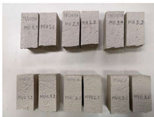
Figura 43_provini derivanti dalla prova a flessione
