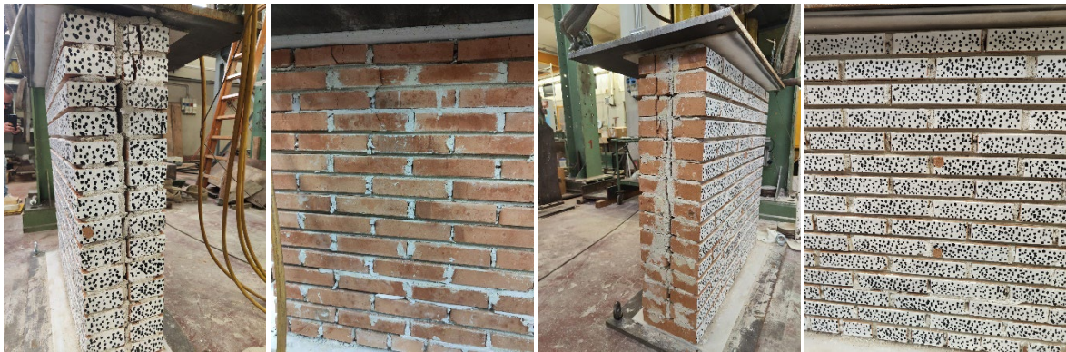
Figura 168_rilievo fotografico in seguito alla prova, facce A, B, C, D (MC_3)
