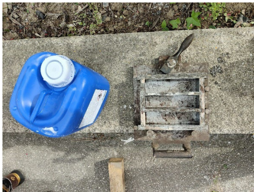
Figura 131_ disarmante (sx), riempimento dello stampo, posizionamento pellicola (dx)
