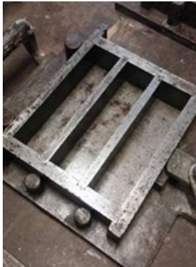
Figura 35_stampo oliato (sx), inserimento malta (dx)
