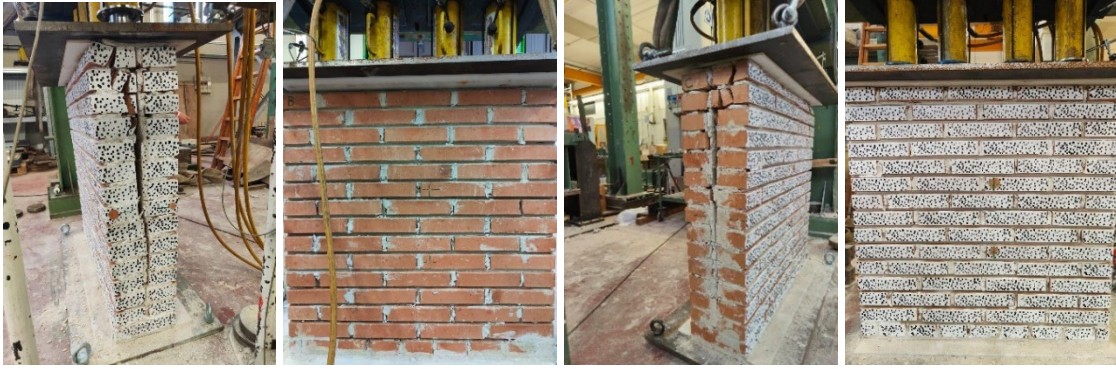
Figura 172_rilievo fotografico eseguito in seguito alla prova, facce A, B, C, D (MC_1)
