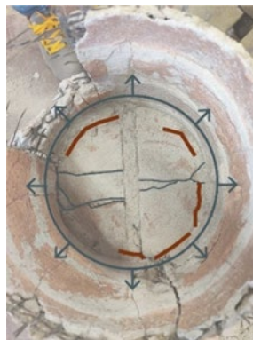
Figura 108_ formazione di fessure a flessione per spanciamento dei lembi esterni (filare 4, CI FRCM_1)
