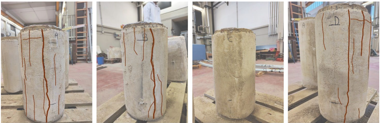
Figura 110_formazione di fessure verticali (CI FRCM_1)
