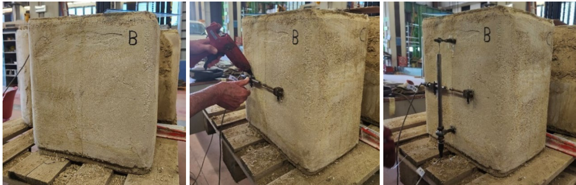
Figura 78_posizionamento dei trasduttori su una colonna
