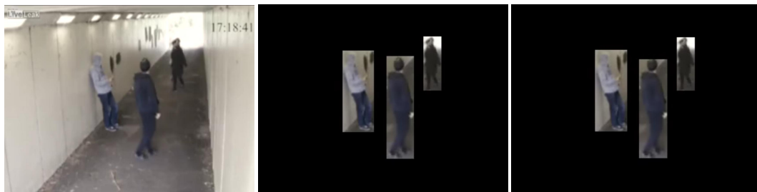
(a) Fotogramma originale (b) Bounding box di YOLO (c) Bounding box di Mask R-CNN
