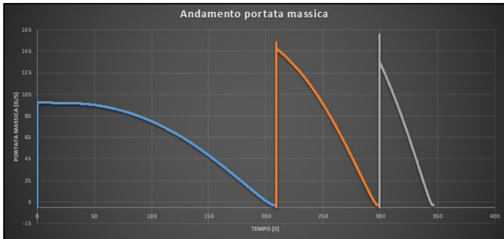
Figura 47 – Simulazione rifornimento completo senza rampa di pressione: andamento della portata massica
