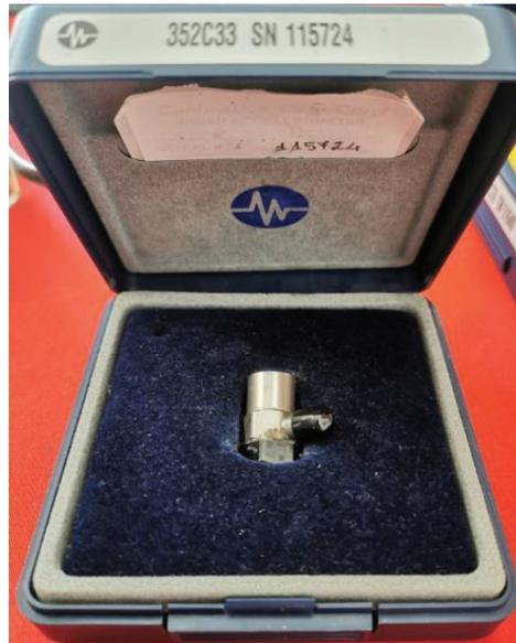
**Figura 6.5:** Sensore Accelerometrico utilizzato nella prova
