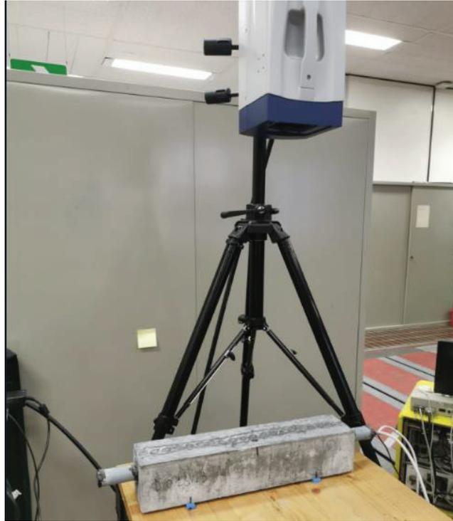
**Figura 6.2:** Vibrometro Laser Doppler a Scansione (LDV)
