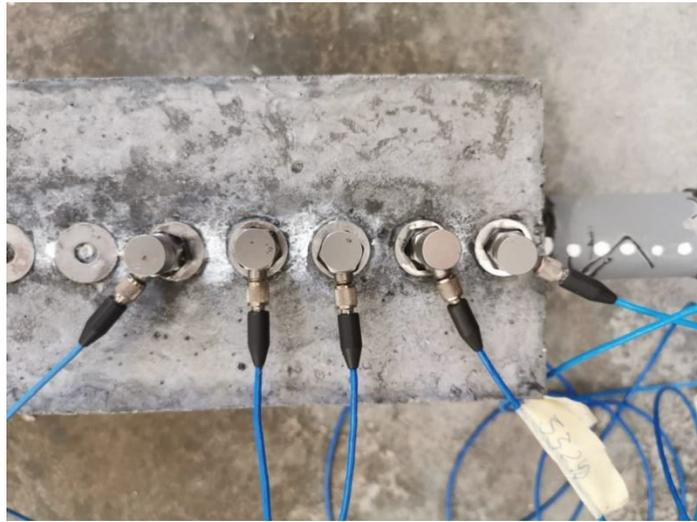
**Figura 6.6:** Montaggio dei cinque sensori all'inizio del test
