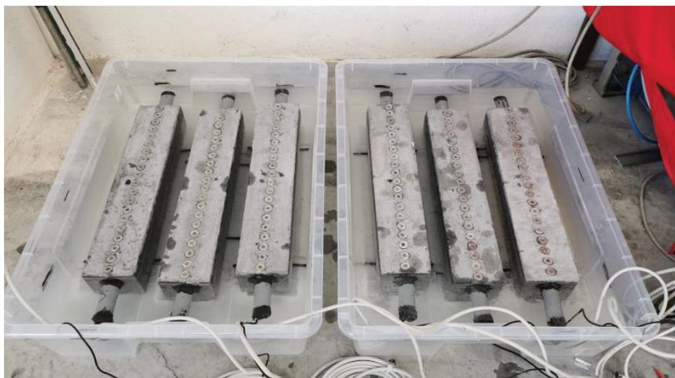
**Figura 3.4:** Fase di immersione per i provini da A a F
