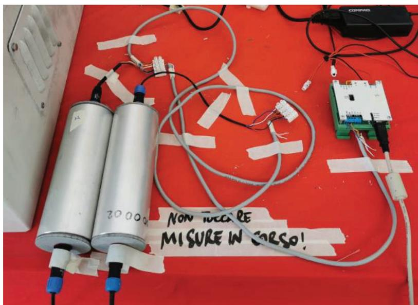
Figura 4.1: Sonde voltmetriche e modulo PC-USB
